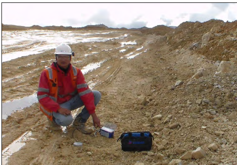
Figura N° 7.3: Muestra la colocación de los equipos para medir las vibraciones.
