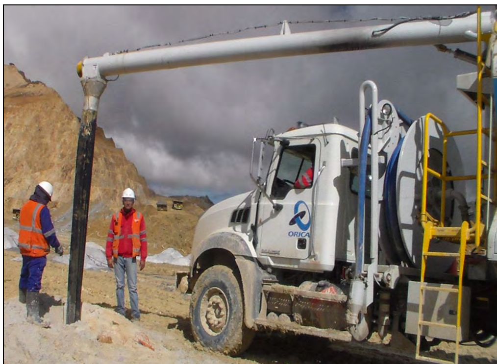
Figura N° 3.9: Muestra la carga cilíndrica típica de una mezcla explosiva comercial.
