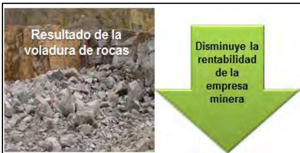
Figura N° 1.2: Fragmentación no adecuada como resultado de la voladura de rocas. Fuente: Yeison Peña Vizarreta
