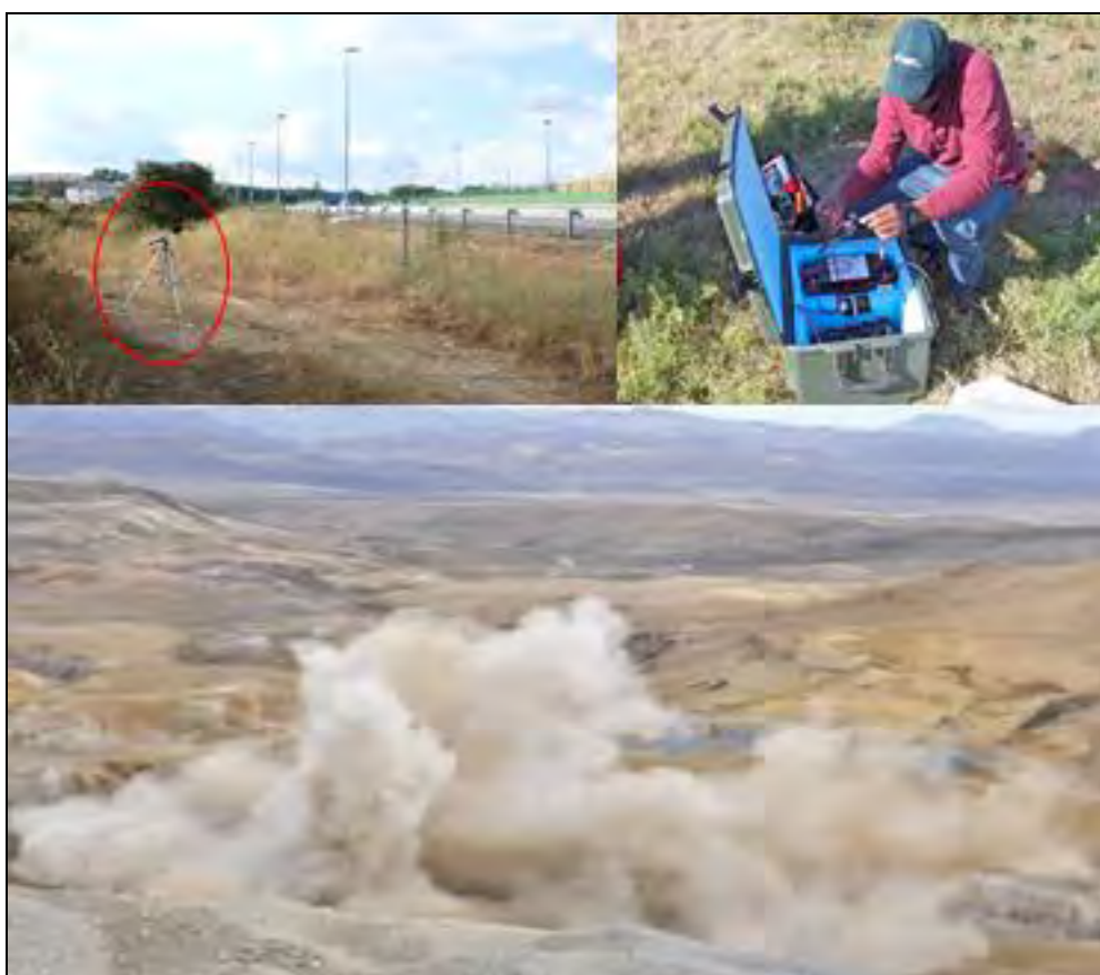
Figura N° 7.1: Muestra una voladura de rocas y la medición de las vibraciones.
