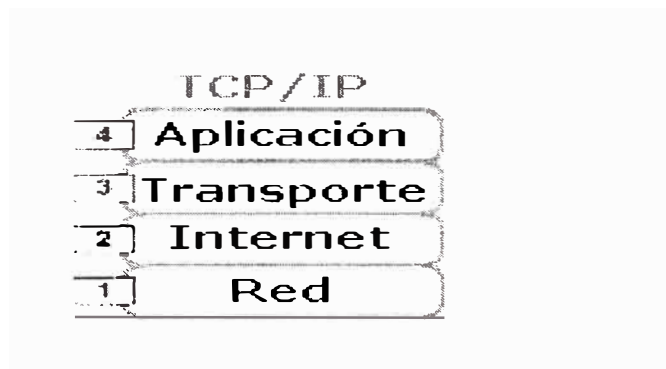
Fig. 4.1 Niveles del modelo TCP/IP
