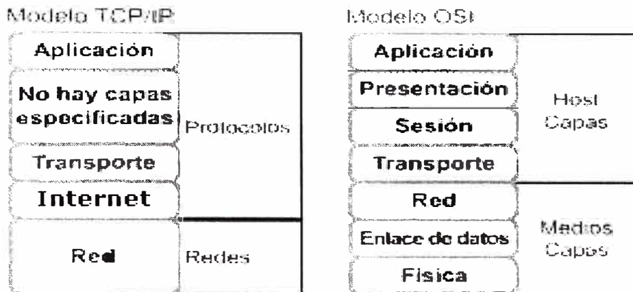
Fig.4.2 Comparación de Modelos TCP/IP - OSI
