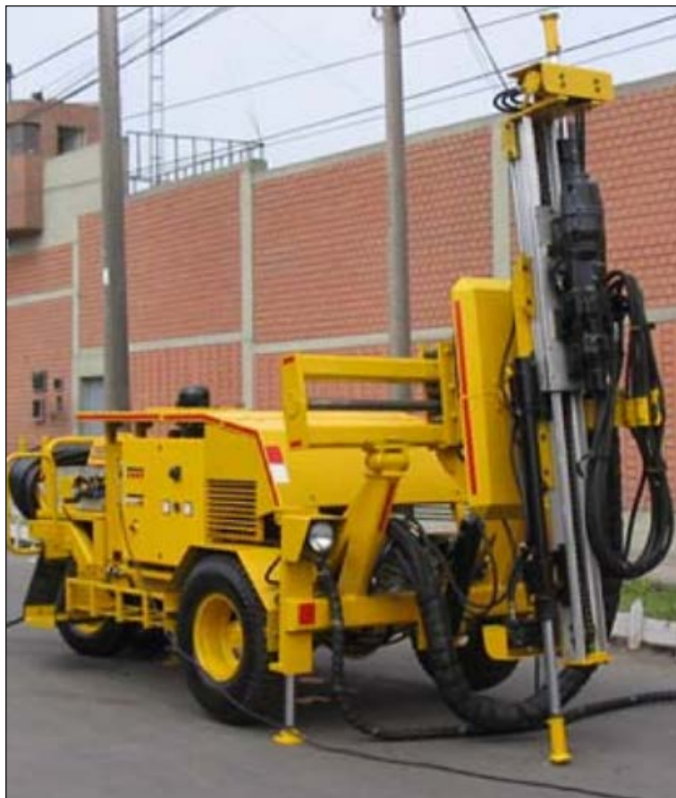
Fotografía 5.1.1 Equipo Raptor Junior para Taladros Largos en Vetas Angostas Fuente: UM Yauliyacu
