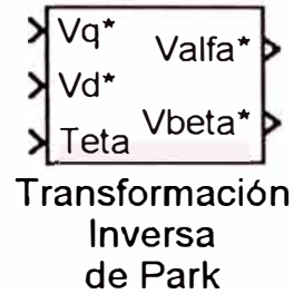
Fig. 4.12. Bloque funcional Transformación inversa de Park
