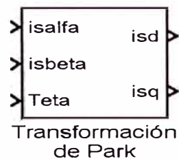
Fig. 4.5. Bloque funcional Transformación de Park
