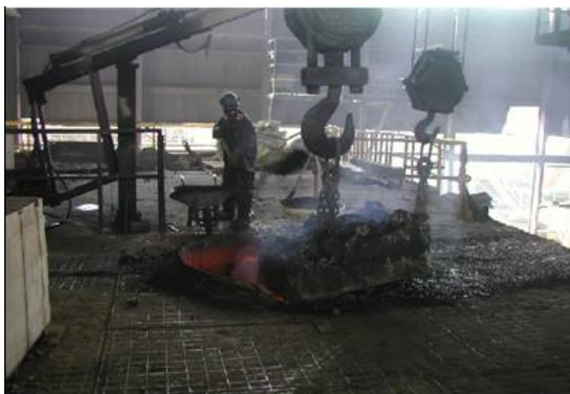
Foto N° 4-14. Alimentación de dross al horno reverbero
