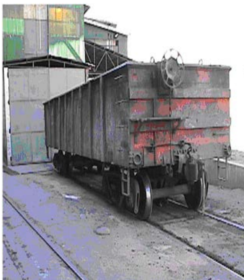
Foto N° 4-30. Carro transportador de lodo
