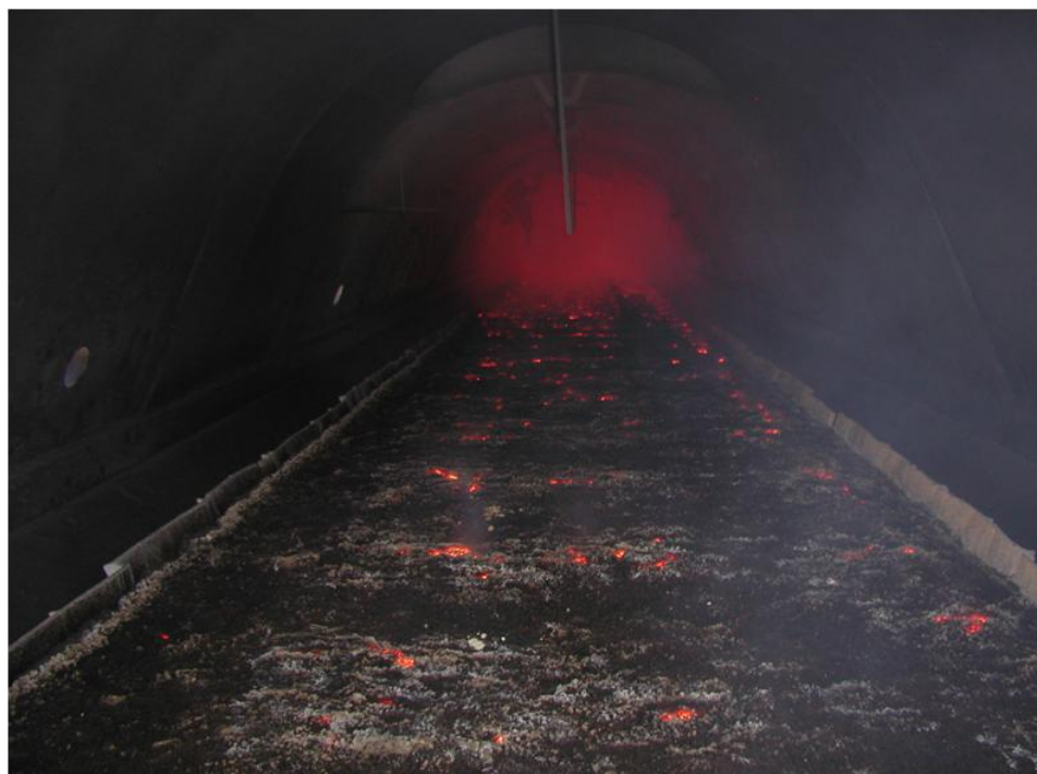
Foto N° 4-6. Interior de la máquina de sinterización
