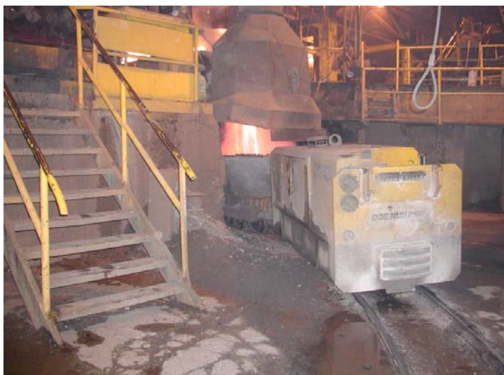
Foto N° 4-11. Plomo de obra recepcionados en tazas
