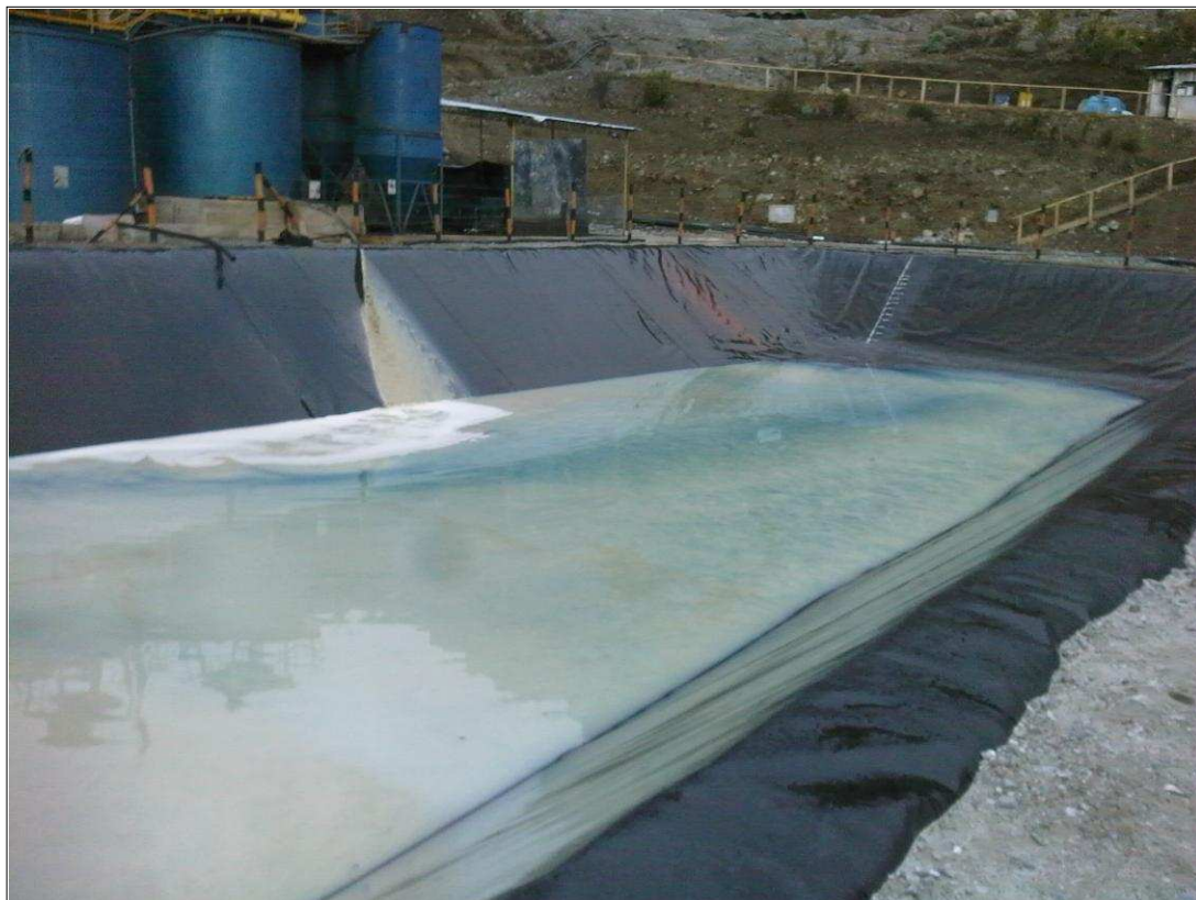
FIGURA 25. Descarga del lodo sobre la poza #1, para su sedimentación.
