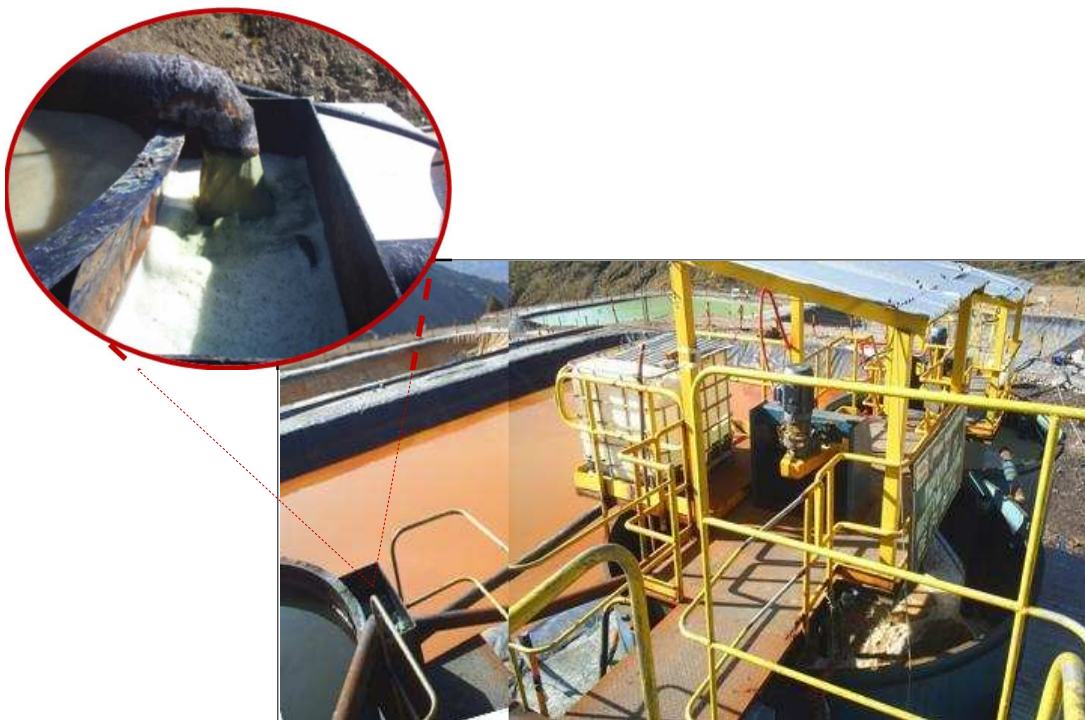
FIGURA 24. Cambio de alimentación del agitador 14'x14' # 1 y # 2.
