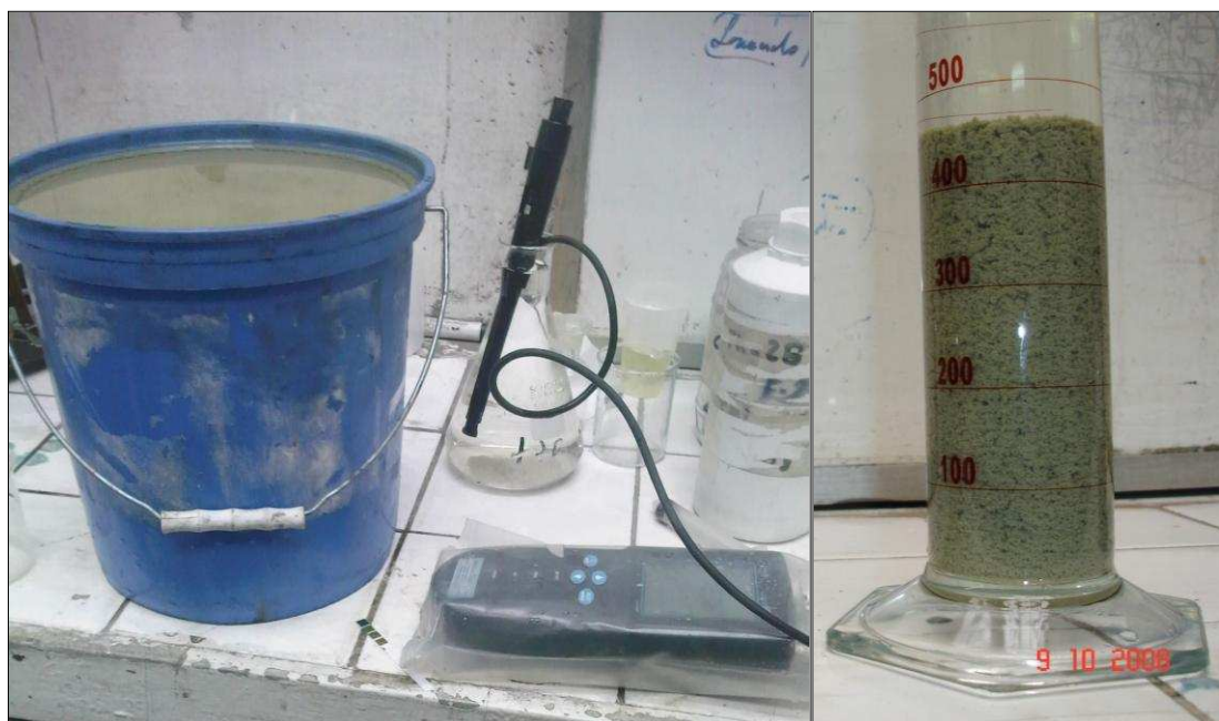
FIGURA 11. Pruebas de precipitación con \text{FeSO}_4 .
