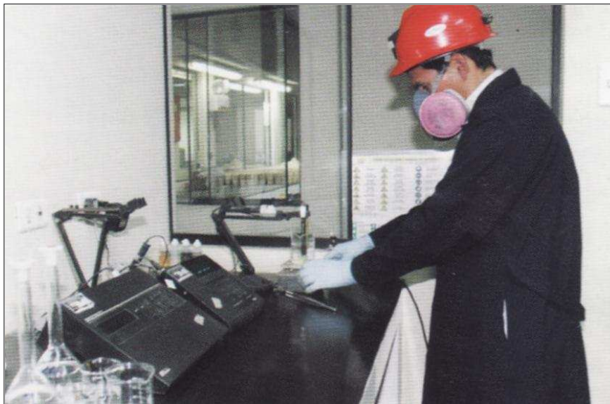
FIGURA 4. Medición del cianuro total en laboratorio químico.
