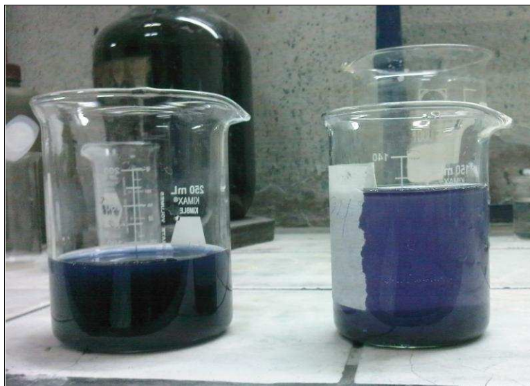
FIGURA 8- Dificultad de sedimentar los lodos en soluciones con contenidos de H_2O_2 .
