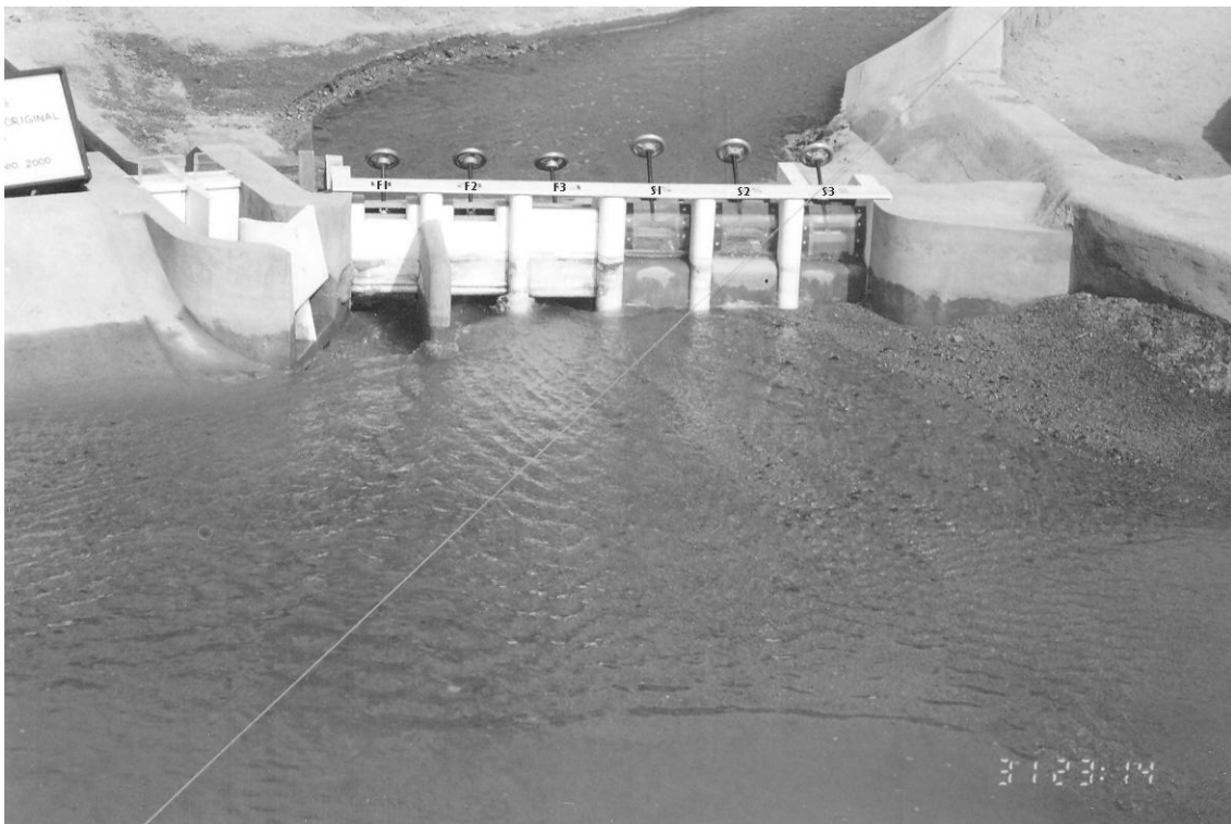
Fotografía 5.6. El flujo descarga con superficie libre (42 minutos desde el inicio, Q=300 \text{ m}^3/\text{s} )
