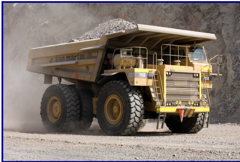
Camión Fuera de Carretera (capacidad 140 TM)
