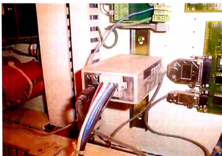
Fig. 2. 27 Módulo 1203-GK5 para comunicación DeviceNet
