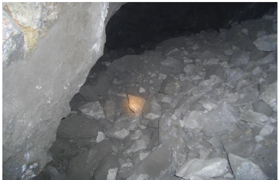
Foto N° 13.- Buena Fragmentación obtenida con una correcta voladura.
