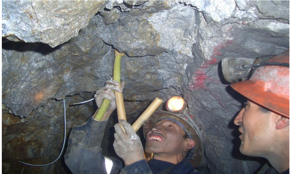
Foto N° 12.- Carguio de taladros con espaciadores plásticos para voladura controlada.
