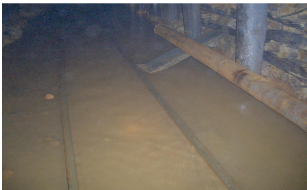
Foto N° 05.- Inundación de la Línea de Cauville y de la vía en general
