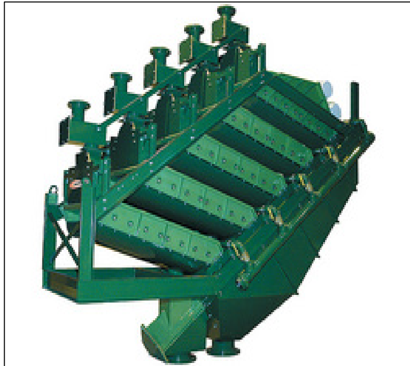
Figura N° 1.1. Stack Sizer de 5 Pisos, equipo implementado en los circuitos de molienda-clasificación.
