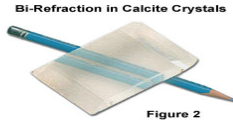
Figura N° 4.3 birefringencia de la calcita
