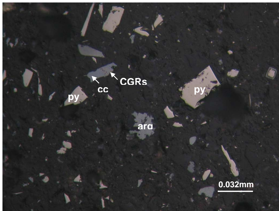
Figura N° 4.14 Microfotografía a 500X de Concentrado Malla -400.- Granos libres de argentita (arg), piritas (py), un grano mixto de cobres grises (CGRs) asociado a calcosina (cc).
