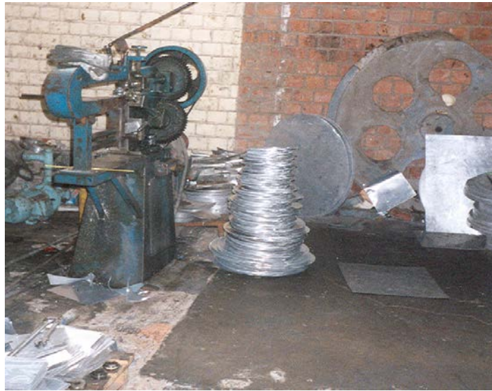
(Fig. 13) Discos Recortados a diferentes diámetros.
