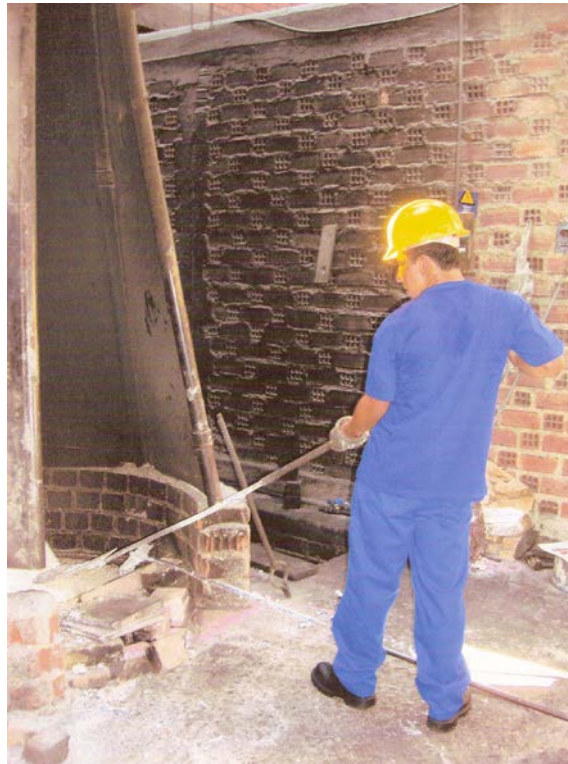
(Fig. 3) Adición de insumos de Fundición y control de Temperatura.
