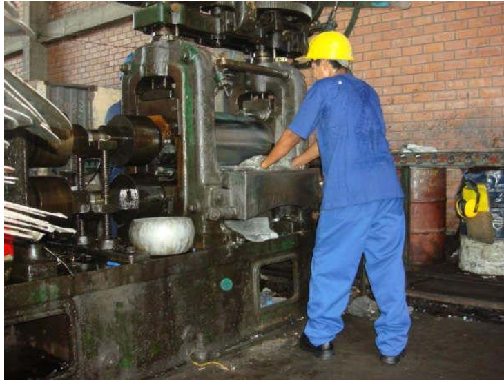
(Fig. 7) Laminadora Marca MINO (de desbaste)
