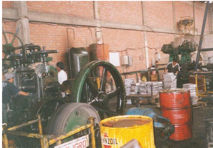
(Fig. 8) Laminadoras Marca MINO Y NASH (de desbaste)
