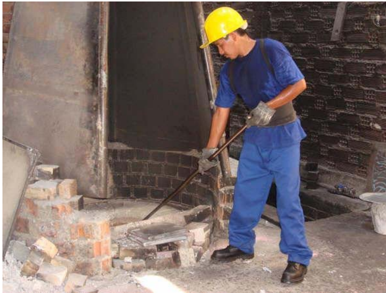
(Fig. 5) Escorificado del aluminio fundido para su posterior colada.
