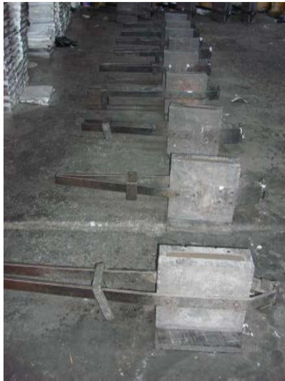
(Fig. 4) Preparación de las matrices para la colada.
