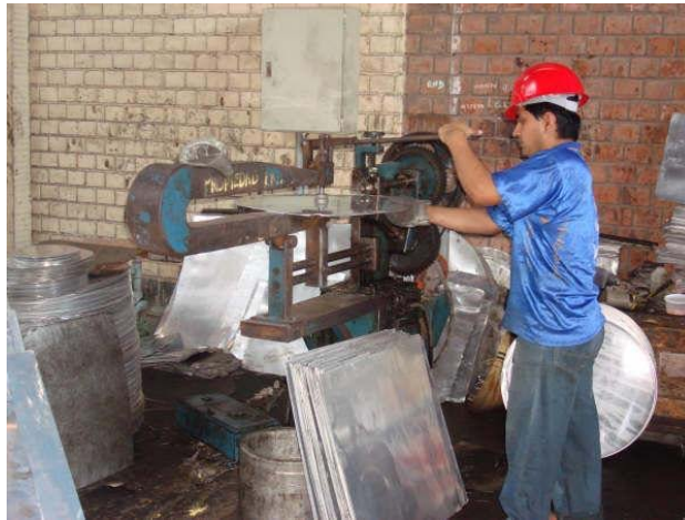
(Fig. 12) Recorte en discos del Aluminio Laminado después del Recocido.
