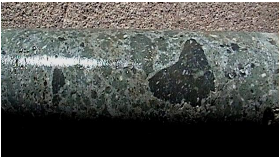
Fig 8 La Silicificación de las andesitas una apariencia de brecha. Testigo zona Tres Reyes SE
