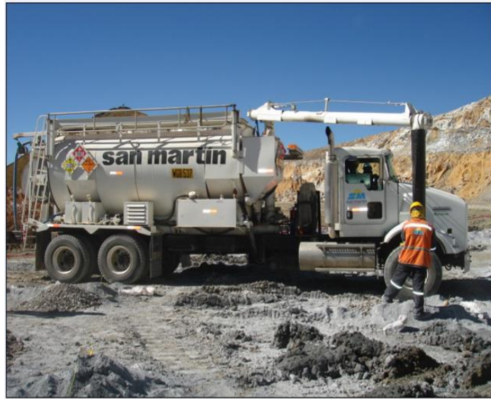
FIGURA 34: CAMIÓN FÁBRICA PARA CARGA DE EXPLOSIVOS; SISTEMA VACIABLE Y BOMBEABLE.
