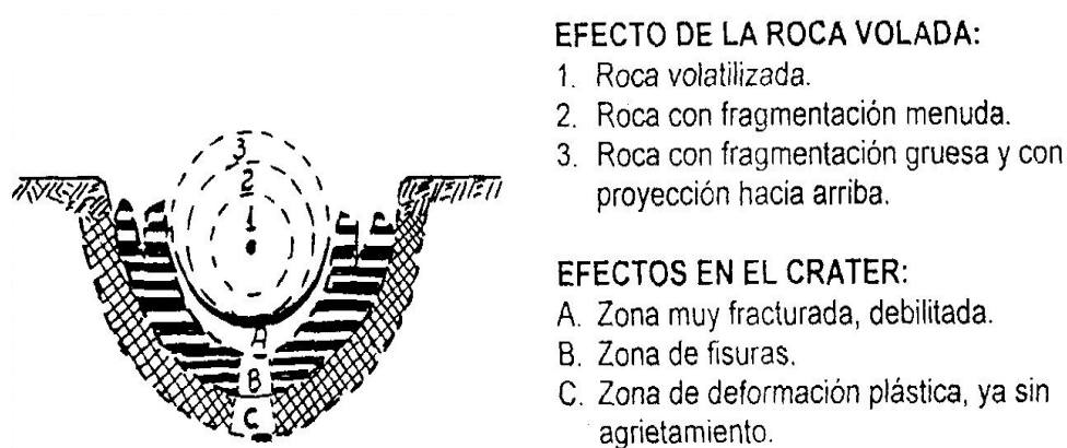
FIGURA 31: EFECTOS DEL PROCESO DE VOLADURA.
