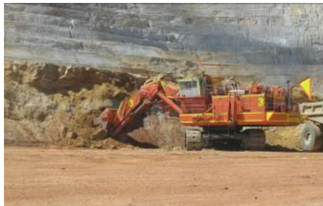
Figura 1.9-7 Limpieza de colas en el frente
