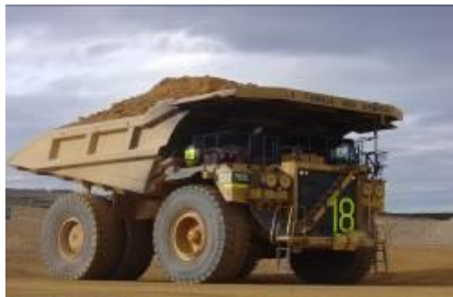
Figura 1.9-9 Camión Cargado correctamente
