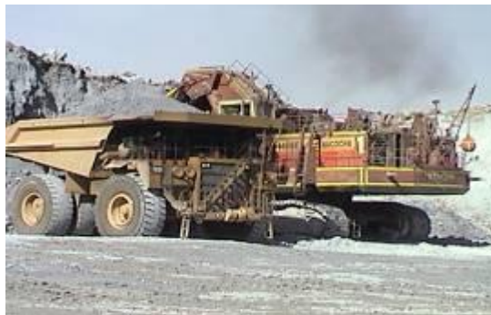
Figura 1.9-11 Carguío de Camión en Rampa
