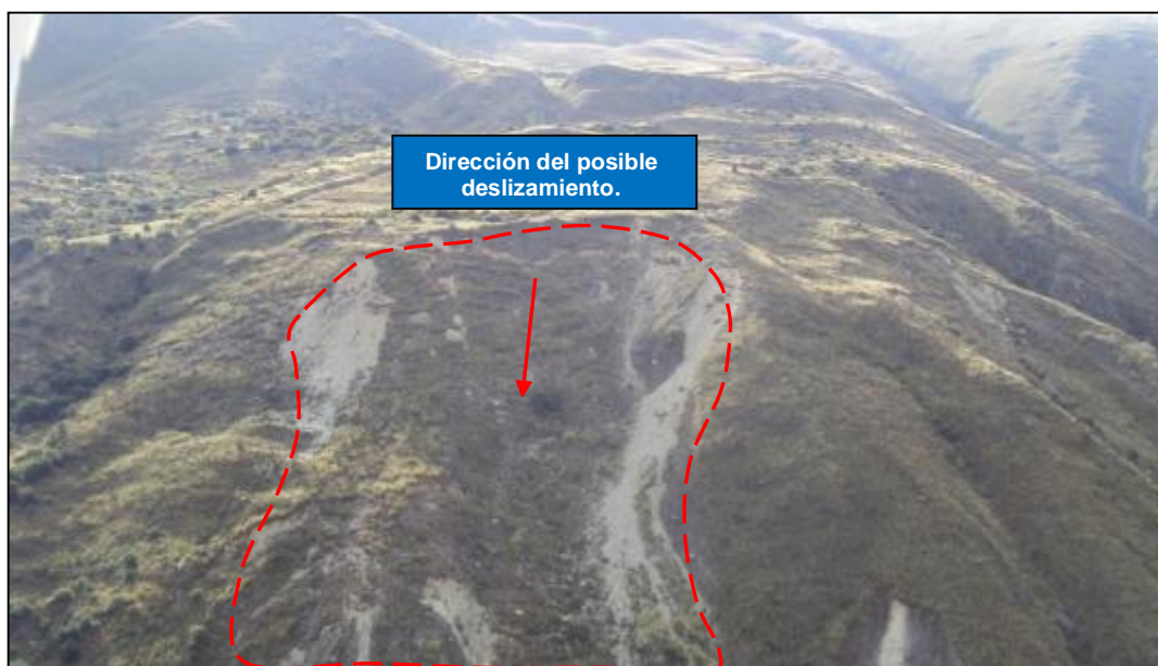
Figura N° 5.9: Parte media de la subcuenca Shullcas frente al paraje Ñuñungayoc, presenta muy alta posibilidad de generar movimientos en masa, vista al N (F. Blanco).
