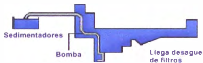
Figura 1.11 Recirculación de Agua de lavado de Filtros.
