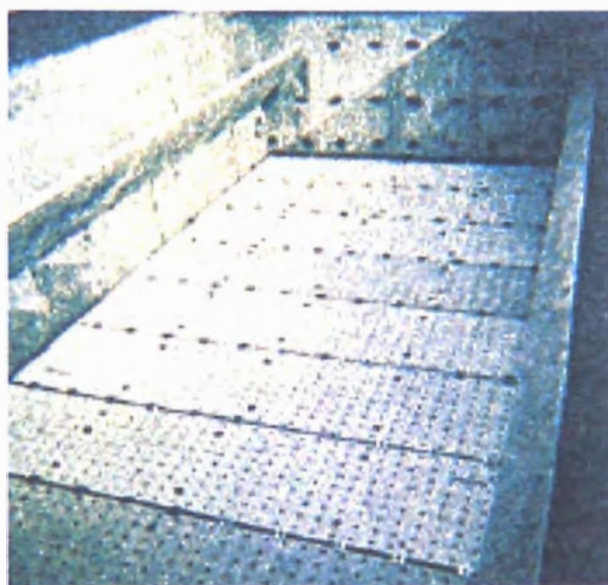
Figura 4.4. Placa de poliéster reforzado; su longitud es igual que la anchura de la célula del filtro
