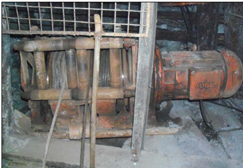
Foto 08: Winche de arrastre de 15 HP. Equipo vital para que la limpieza mediante el Longwall sea rápida.
