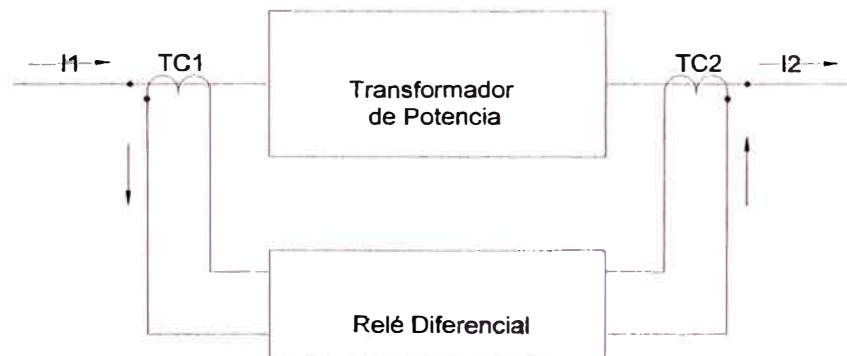
Fig. 2.1. Diagrama de conexión típico de un relé diferencial
