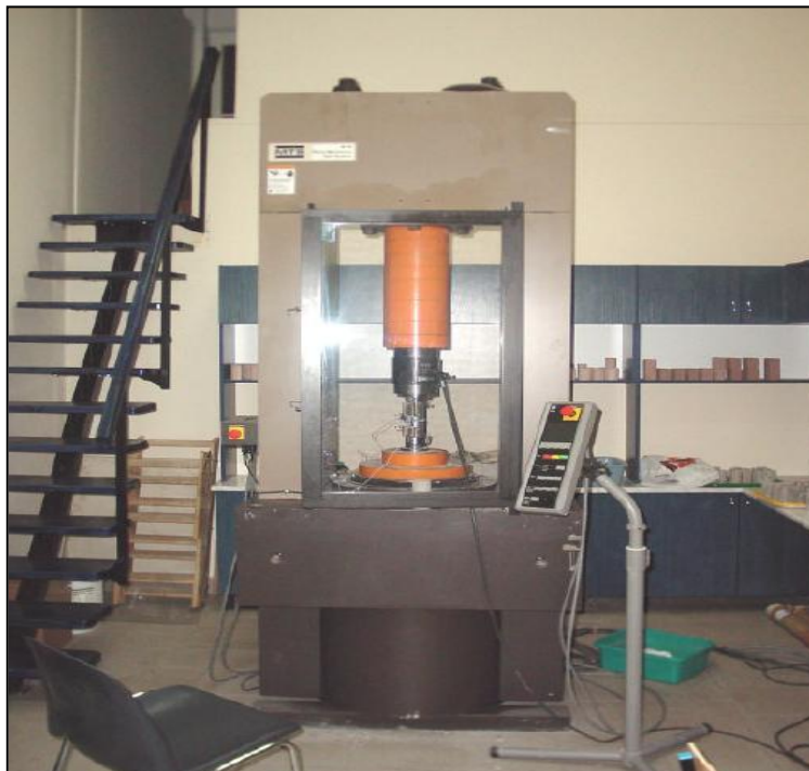
FIGURA 9: Muestra de la roca establecida en la prensa rígida, conectada con una consola de manejo.
