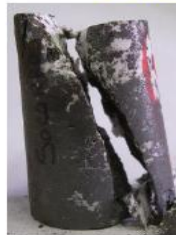
FIGURA 10: Presenta la superficie de contacto, el modo de fallamiento y también la superficie de corte de la muestra. Esta figura presenta las especificaciones de la muestra mineral.
