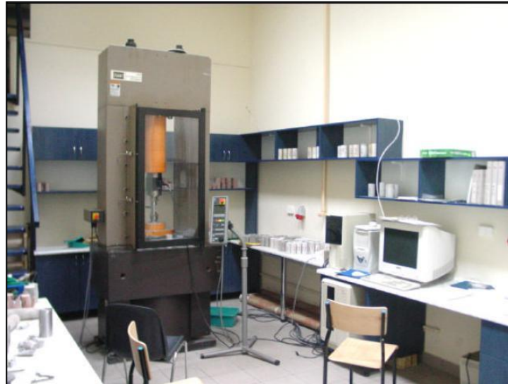
FIGURA 7: Vista de la prensa rígida MTS-815 en el MTS Laboratorio del Departamento Geomecánica, Genio Civil y Geotécnica en la AGH - Universidad de la Ciencia y Tecnología en Cracovia.
