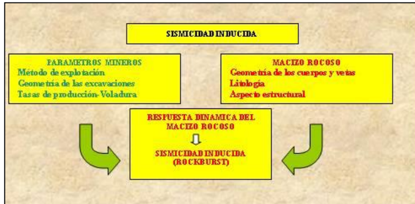
FIGURA 19: Gráfico de los factores que influyen para que se genere la sismicidad inducida
