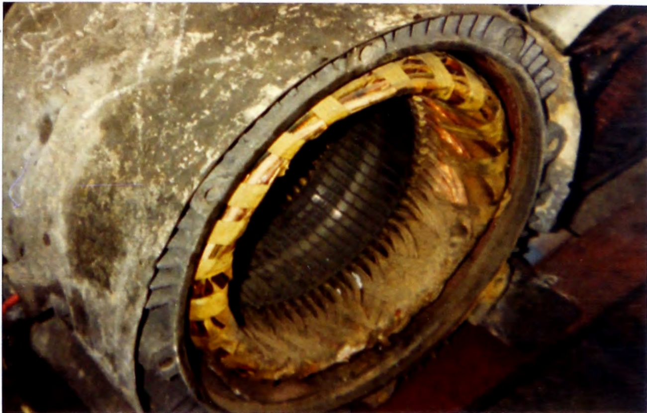
Núcleo magnético averiado (cortocircuitado)
