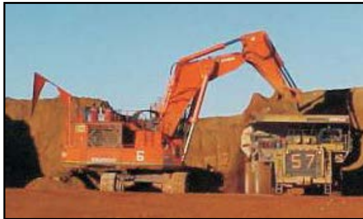
Fig. 2 Excavadora Hitachi EX2500
