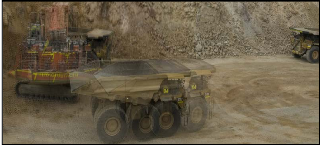
Fig. 5. Pala terminando de cargar un camión para comenzar a cargar el siguiente.
