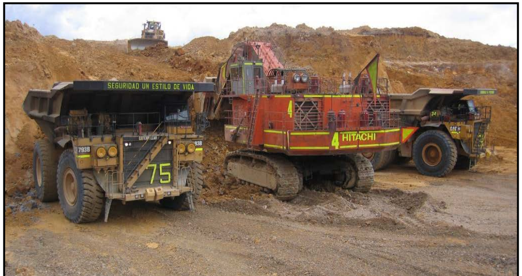
Fig. 1. Pala Cargado camión en un frente duro
