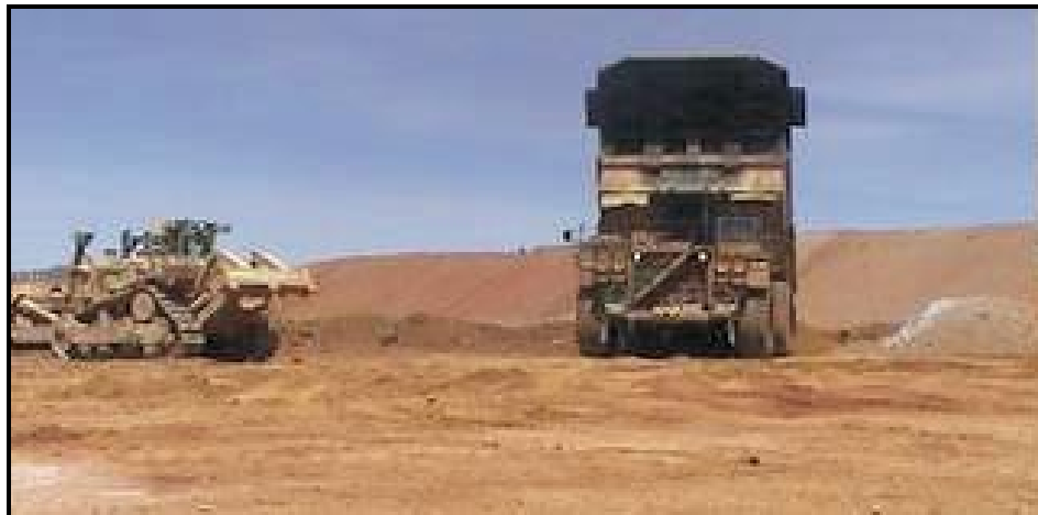
Fig. 11 Camión descargando en el Pad de Lixiviación.
