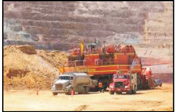
Fig. 3. Abastecimiento de combustible de pala
