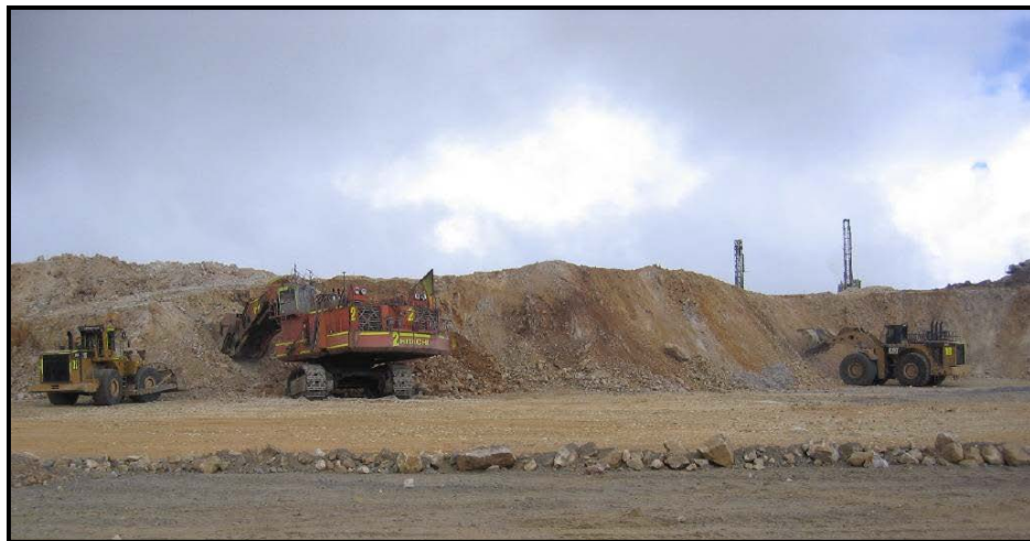
Fig. 6. Pala terminando de cargar un camión para comenzar a cargar el siguiente
