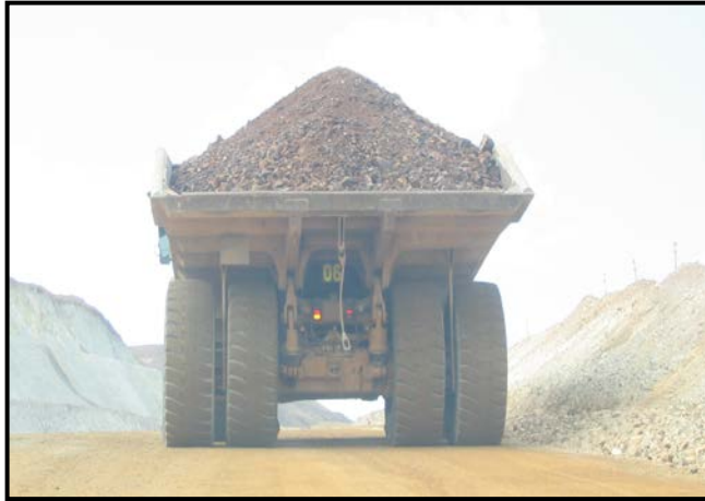
Fig. 7. Camión con buen payload y distribución de carga
