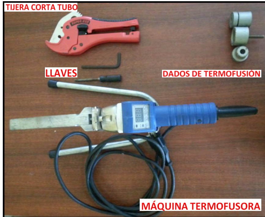
Figura n°12: Equipo de termofusión de 800 watts y accesorios para la termofusión
