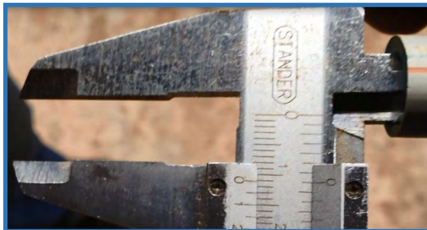
Fotos n°44: Medición diámetro interior 11.1 mm
