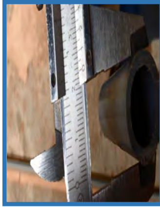
Foto n°84: Diámetro exterior PVC 1/2" 21 mm.
