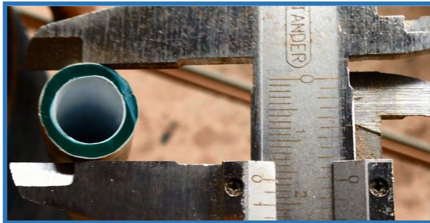
Fotos n°43: Medición del Diámetro exterior 16 mm
