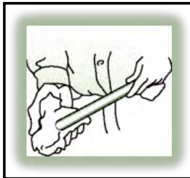
Figura n° 17: Limpiado y secado de la tubería de polipropileno.
