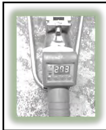
Figura n°15: Temperatura de la máquina termofusora.
