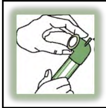
Figura n° 21: Detener la introducción de la tubería después de alcanzar las marcas.
