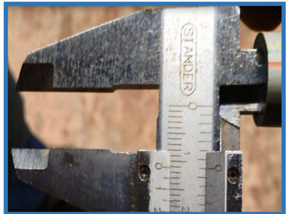
Foto n°37: Diámetro interno de la tubería PP-R.
