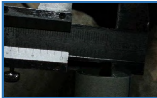
Foto n°58: Diámetro Interior tubería de 25 mm.
