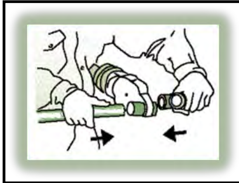
Figura n° 19: Introducción de las tuberías y accesorios a la termofusora
