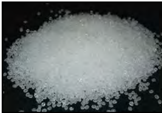
Figura n°5: La materia prima PP-R consta de esferas cristalinas
