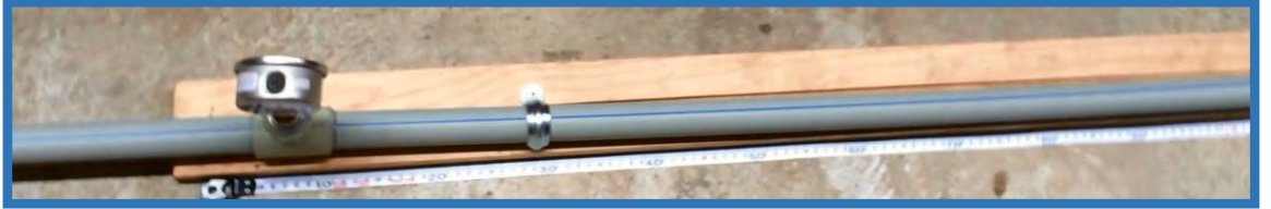
Foto n°67: Tubería de prueba de 32 mm.
