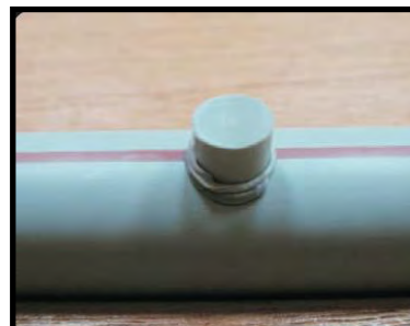
Foto n° 10: Reparación por tarugos.
