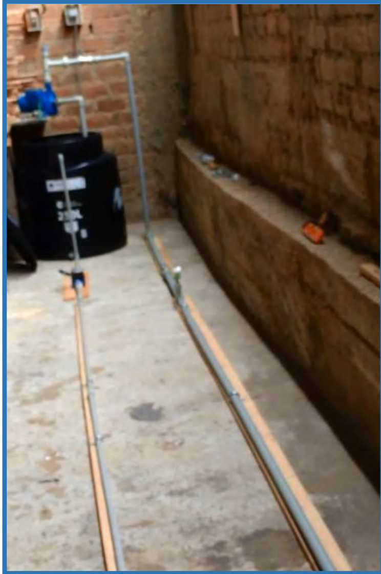
Foto n°66: Línea de impulsión 32 mm, manómetro inicial, tubería de 32 mm, tubería de retorno de 20 mm y medidor volumétrico.
