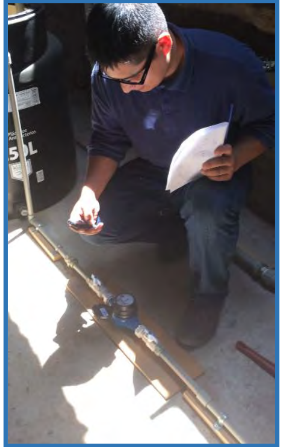
Foto n°39: Encendido del cronómetro en el mismo instante que empieza a registrar el medidor.
