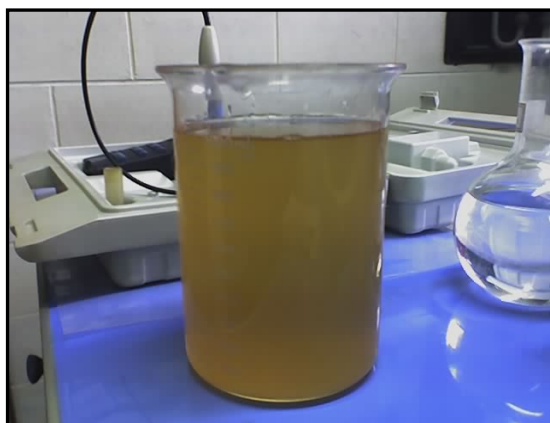
Fig. 3.8: Agua ácida de mina (pH = 2.8)
