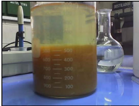
Fig. 3.9: Agua neutralizada con cal (pH = 7.37)
