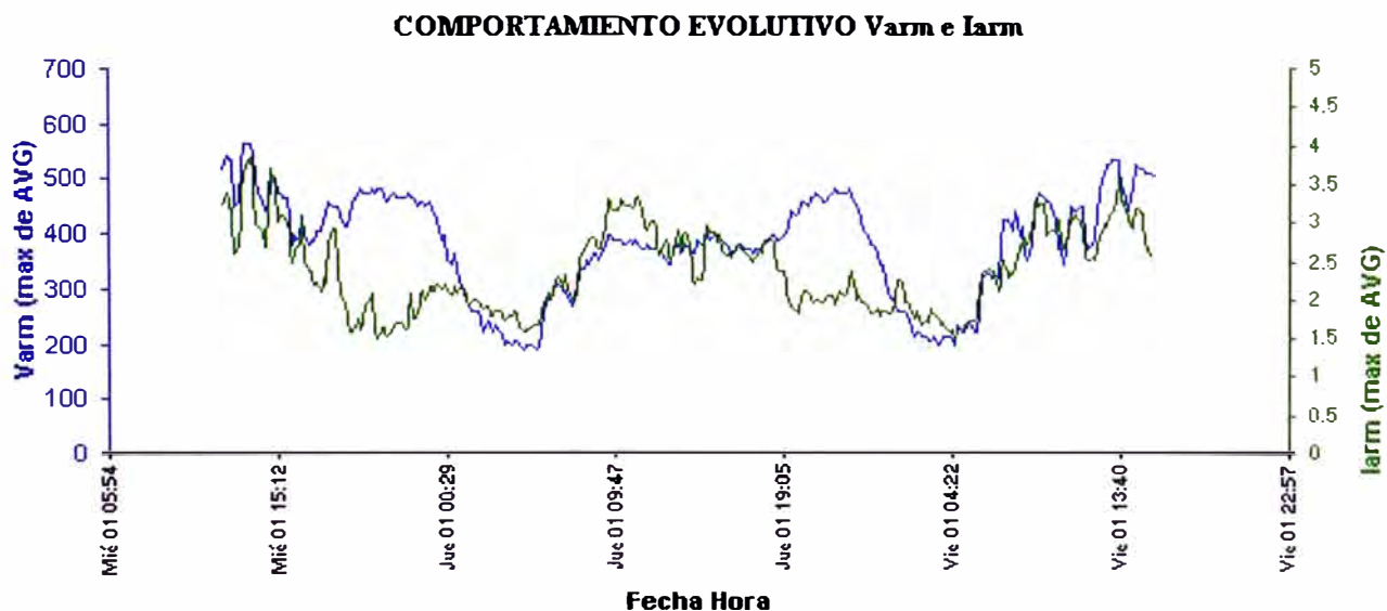
Fig 3.4 Evolución de la corriente y la tensión armónica de orden 5° para Filasur.
