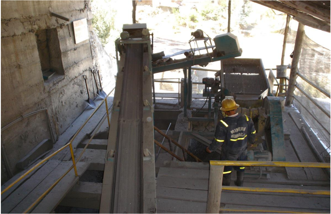
Chancadora de Quijadas 8" * 10" , fajas transportadora y zaranda vibratoria
