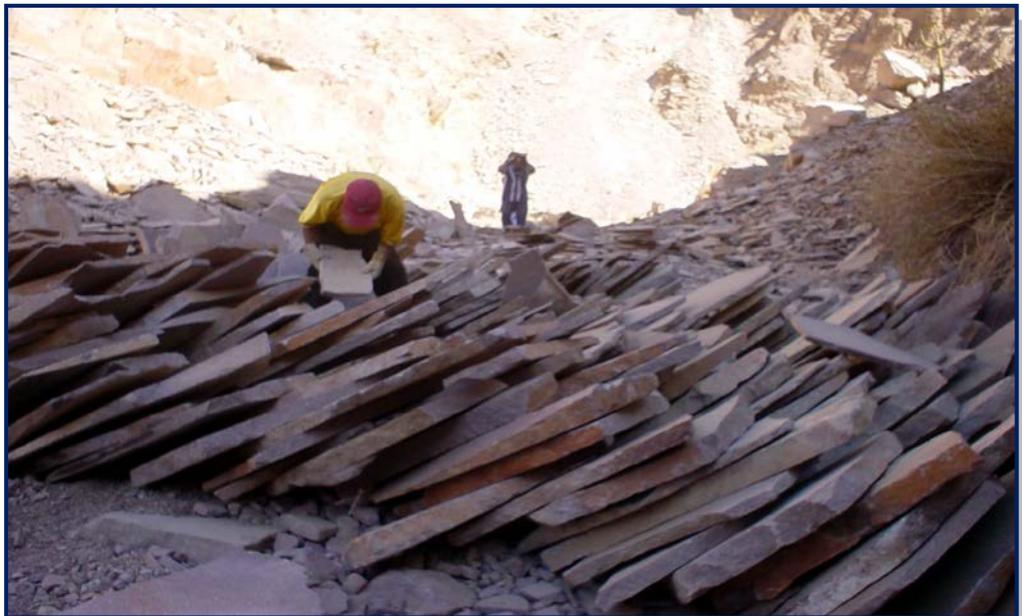
**Figura N° 3.2: Seleccionando piedra para carguío y traslado a taller.**
