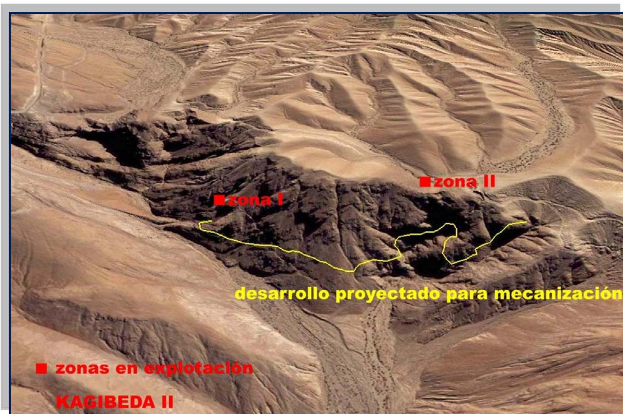
Figura Nº 2.4: KAGIBEDA II, Ubicación de las zonas en explotación y el trazo del acceso proyectado para el desarrollo y la explotación mecanizada de la cantera.
