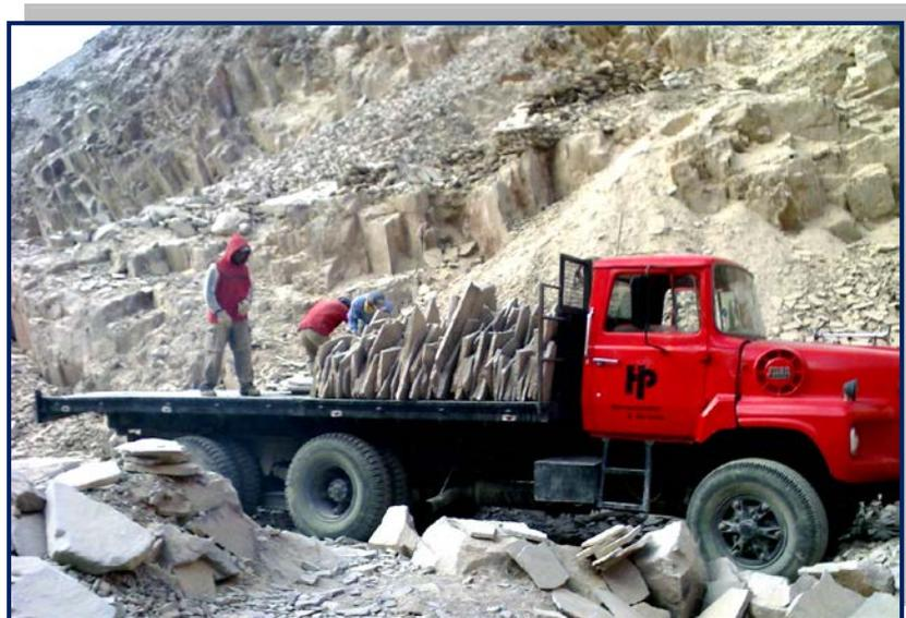
**Figura N° 3.5: Cargando la piedra seleccionada para trasladarla a obra.**
