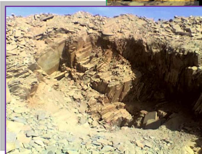
**Figura N° 2.8:** Las trincheras de exploración ejecutadas en la cantera KAGIBEDA han servido para la determinación de reservas y la comprobación de la calidad de la piedra.
