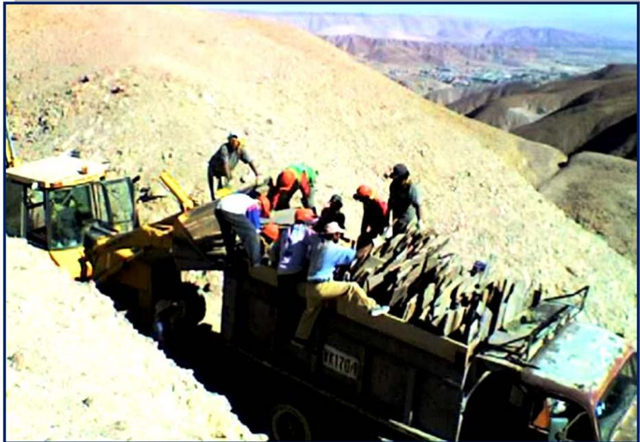
**Figura Nº 3.6: Trasladando la piedra en un volquete pequeño desde un banco con acceso reducido, se requiere doble manipuleo y el uso de la retro excavadora, haciendo más costosa la operación.**
