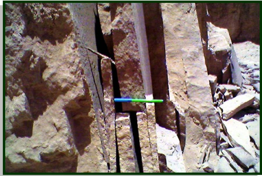
Foto N° 4: Detalle del espesor de la piedra tal como se presenta en cantera.
