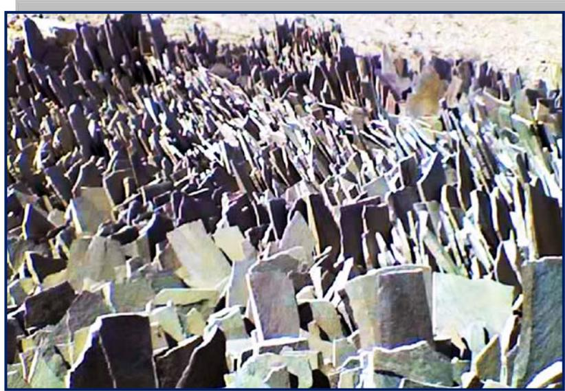
**Figura Nº 3.7: Cancha de acopio de piedra laja extraída, para selección y posterior traslado a obra o taller.**
