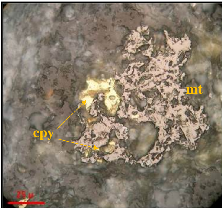
Fotomicrografía N° 16: Luz reflejada. Nícoles paralelos. Intercrecimientos de magnetita y calcopirita en la matriz microcristalina. (Sección pulida de la foto N° 13).
