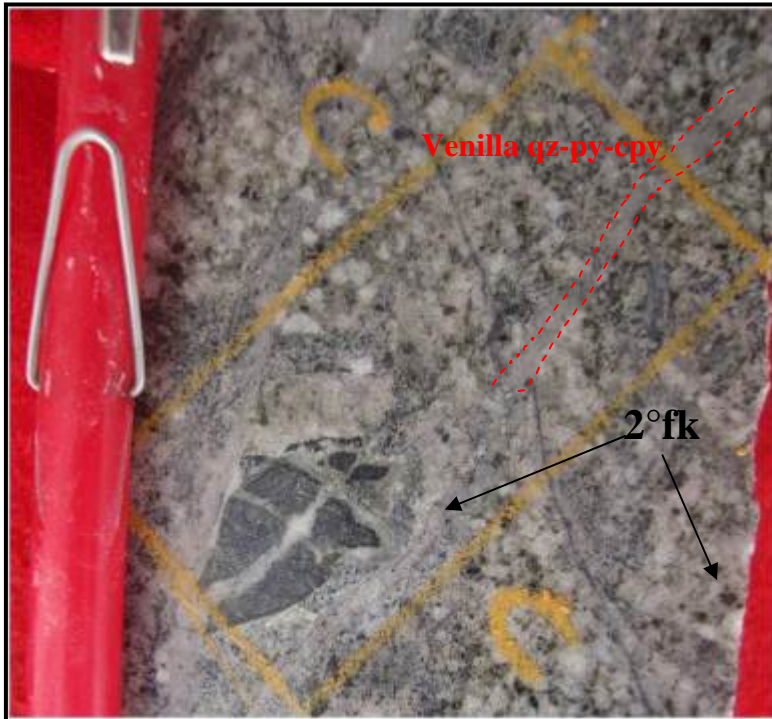
Foto N° 10: Granodiorita intramineral (T-IMG), con fuerte alteración potásica (Fk-Bt-Mt), con presencia de venillas de cuarzo. (MOR-002, 93.40m). Muestra de sondaje.
