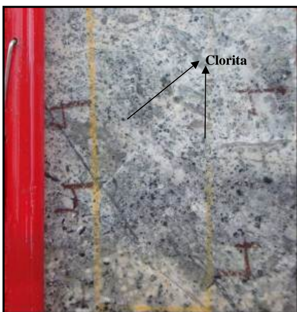
Foto N° 15: Fotografía de una muestra del sondaje MOR-002 (223.00m) T-IGD. Nótese la débil alteración potásica, sobreimpuesta por una alteración clorítica selectiva reemplazando principalmente a la biotita secundaria. Contiene 1.11 gr/t Au 0.20% Cu.
