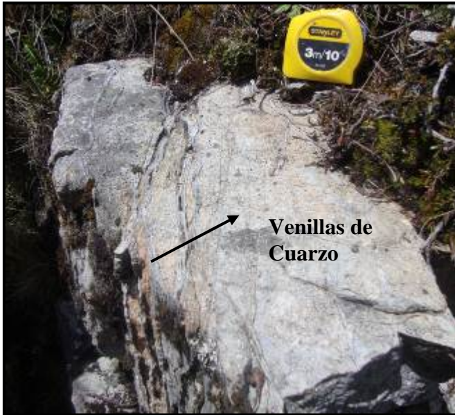
Foto N° 29: Fotografía de afloramiento. Se observa el desarrollo de las venillas de cuarzo tipo A, formando un “sheet veins”, dentro de la T-IGD, con desarrollo de alteración potásica moderada de Fk – bt.
