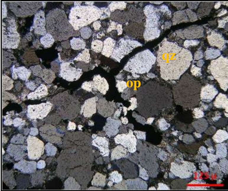
Fotomicrografía N° 8: Luz transmitida. Nícoles cruzados. Venilla de cuarzo de textura equigranular, con presencia de minerales opacos (cpy). (Sección delgada de la foto N°22).
