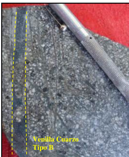
Foto N° 12: Fotografía de una muestra de afloramiento. Nótese la intensa alteración potásica (Bt) en la T-IGD, la cual está asociada con diferentes tipos de venillas de cuarzo.
