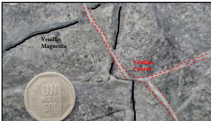
Foto N° 31: Fotografía de una muestra del sondaje MOR-002 (127.40m). Presenta venillas de magnetita desplazadas por venillas de cuarzo tipo B, en una intensa alteración potásica. Contiene 0.75ppm Au y 0.29% Cu.
