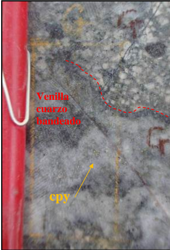
Foto N° 37: Microgranodiorita intramineral (T-IMG) con alteración potásica. Venillas de cuarzo-magnetita-pirita-calcopirita. Muestra de sondaje.
