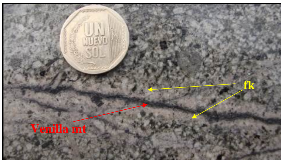
Foto N° 24: Fotografía de una muestra de sondaje, nótese la presencia de venillas de magnetita con halos de feldespato potásico, en la microgranodiorita principal (T-MGD), con alteración potásica moderada de feldespato potásico – biotita.
