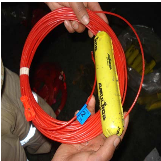
Fig. 10: Accesorios y explosivos usados en el T-1915.
