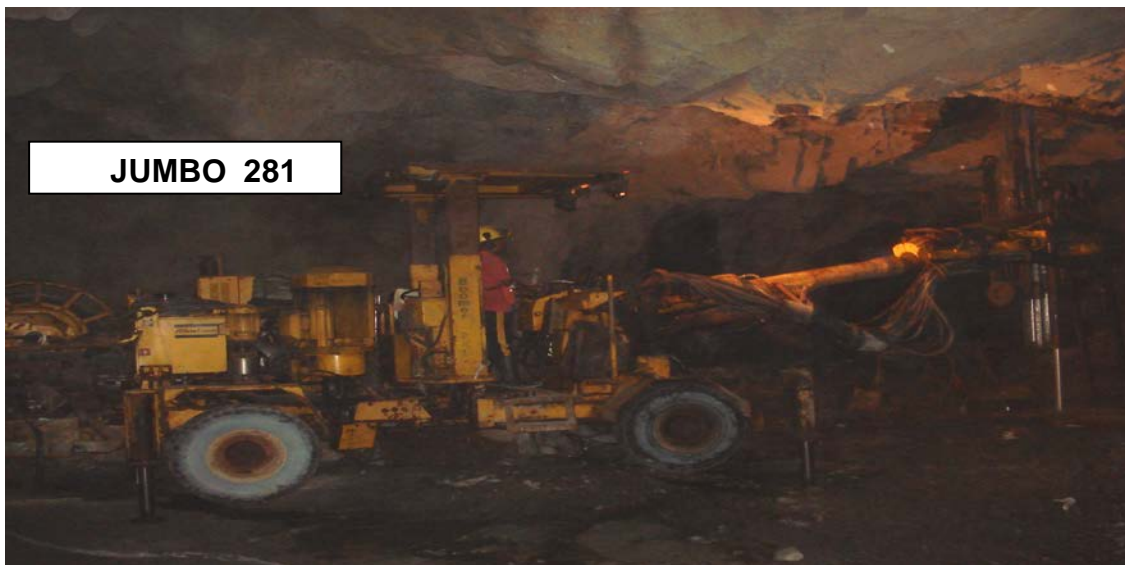
Fig. 7:Equipo Jumbo 281 en operación.
