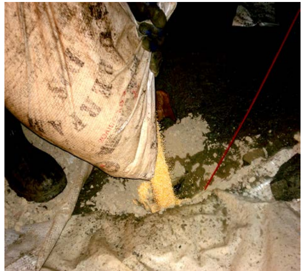
Fig.16 :Carguío de taladros de producción T-196 método LBH
