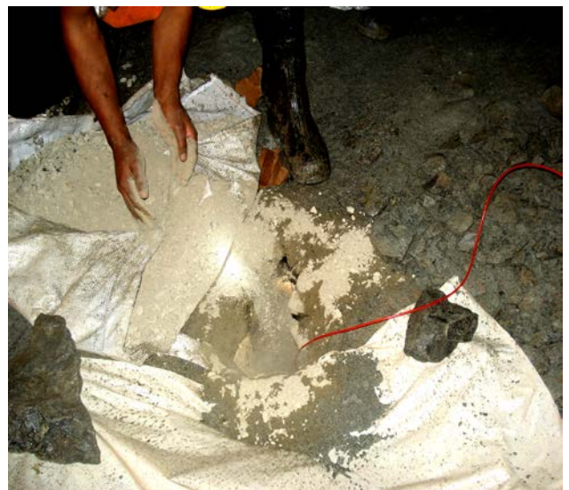
Fig.16 :Carguío de taladros de producción T-196 método LBH
