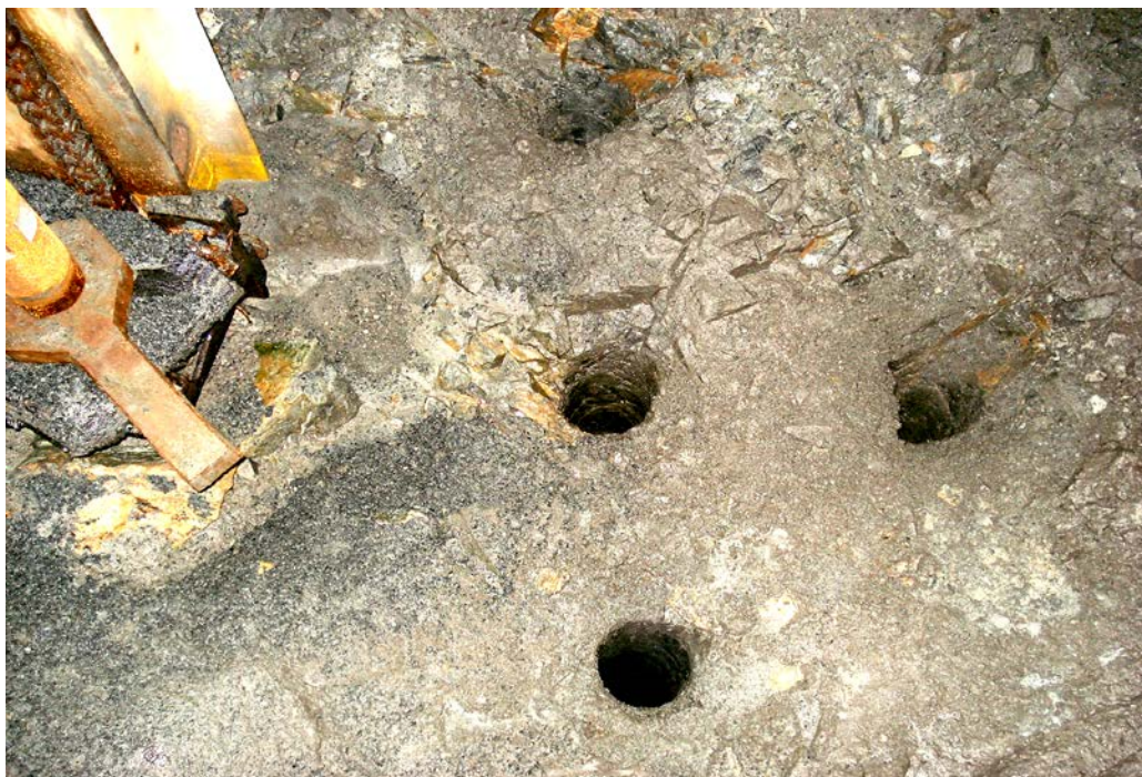
Perforación CH-772-1 método VCR.
