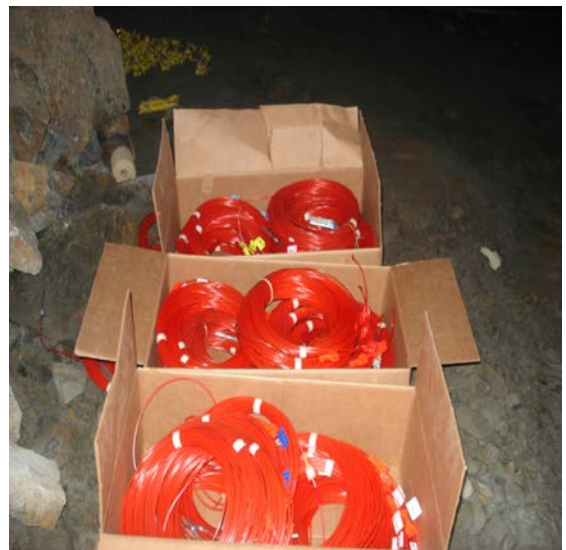
Fig. 10: Accesorios y explosivos usados en el T-1915.
