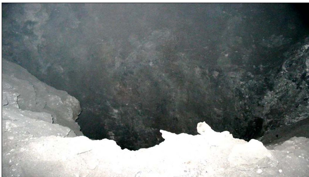
Fig 24: Vista del cráter después del disparo final CH-772-1 método VCR.
