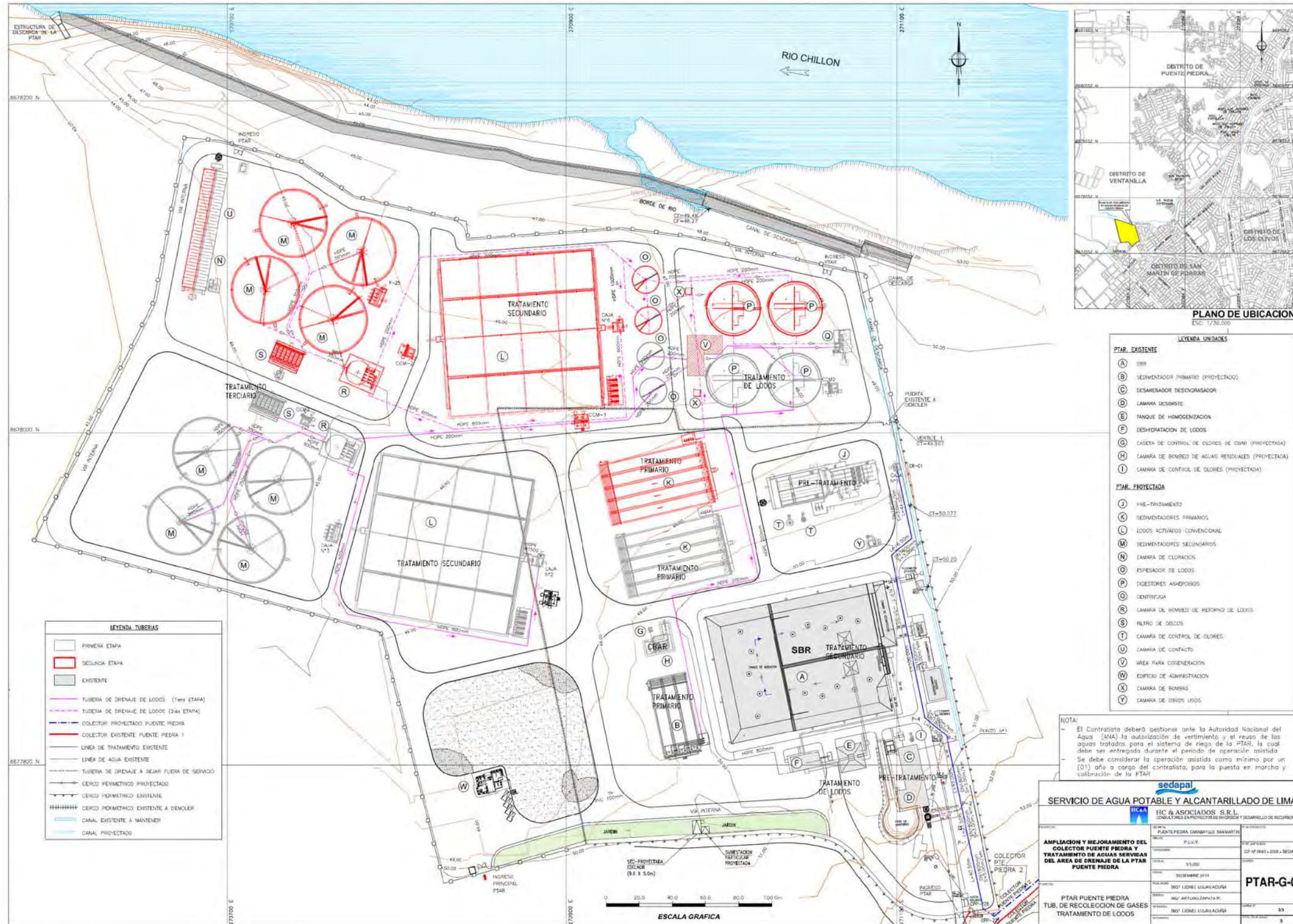
Mapa N° 03: Ampliación de la PTAR Puente Piedra – Tubería de recolección de gases - Tratamiento de lodos
