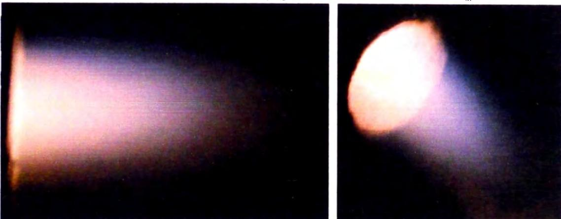
**Figura. 4.14: Ensayo experimental del quemador,  $Q = 41.2/42.7KW$ .**
