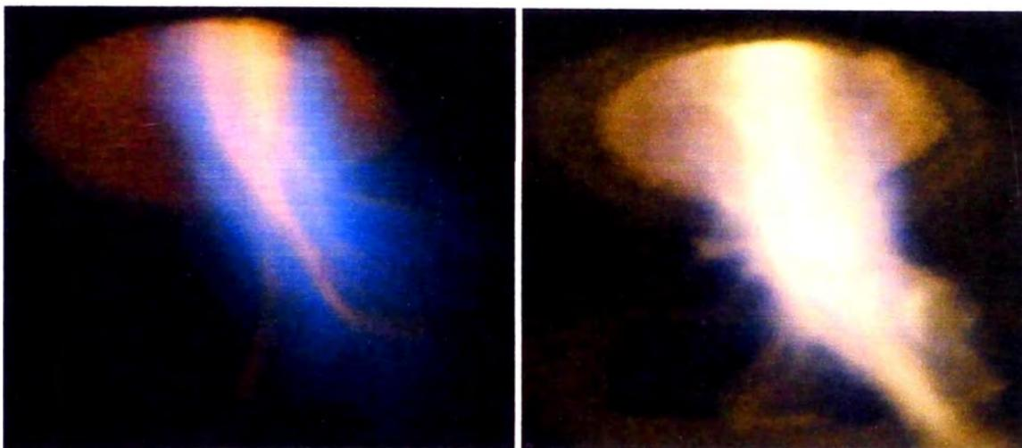
**Figura. 4.37: Comparación de regímenes en mezcla rica  $\Phi = 1.22/Q = 7.7KW$  (izquierda), y  $\Phi = 1.03/Q = 21.4KW$  (derecha).**
