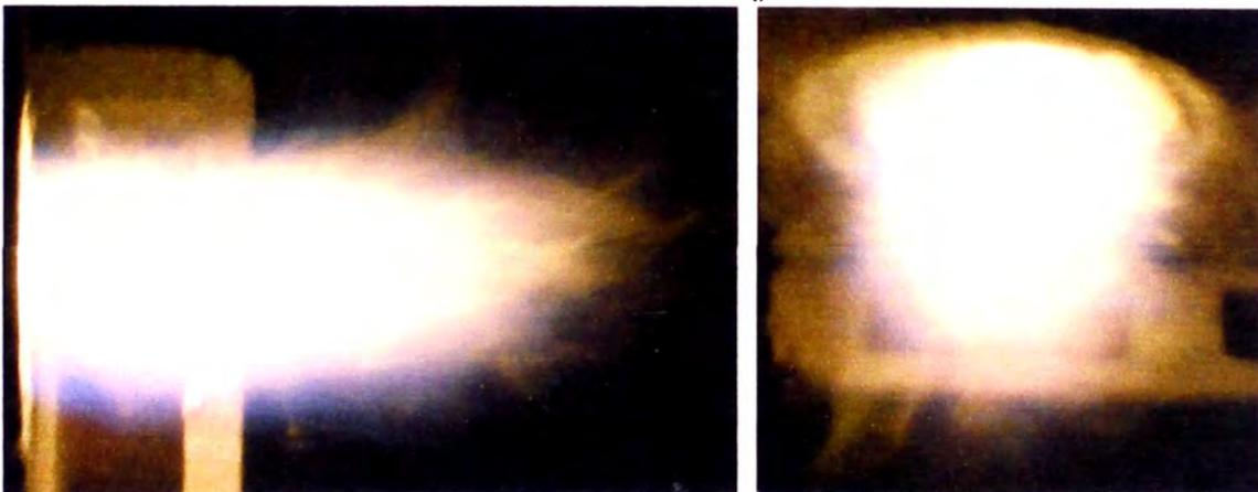
**Figura. 4.9: Ensayo experimental del quemador,  $J_{sr} = 2.5$ ,  $\Phi = 1.03$ .**
