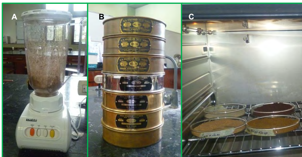
Figura 3.2. Preparación de biosorbentes: A. Triturado, B. Tamizado, C. Desecado
