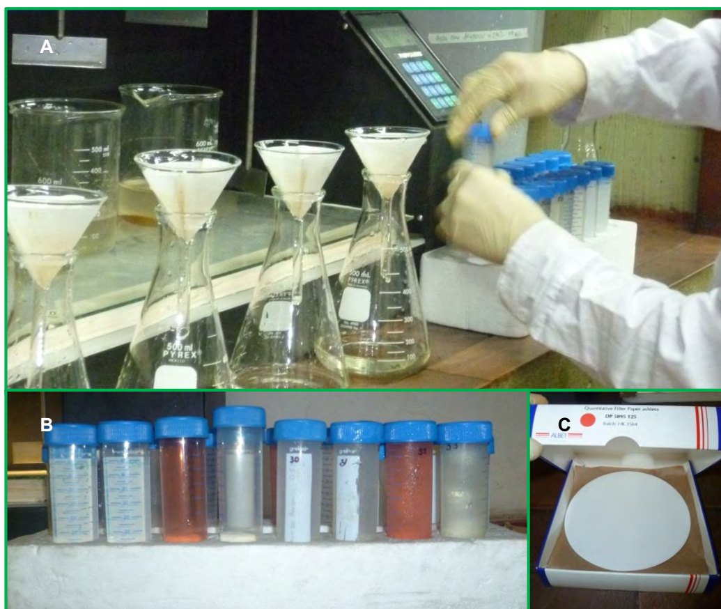
Figura 3.4. Filtrado y acondicionamiento de muestras finales. A. Filtrado de muestras finales, B. Muestras finales acondicionadas para almacenamiento, C. Papel filtro utilizado.
