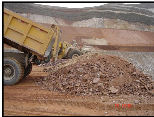
Foto 11 Volquete descargando el mineral en el Pad
