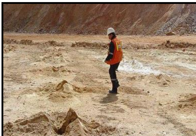
Foto 14 Supervisor verificando el muestreo en los taladros para Voladura
