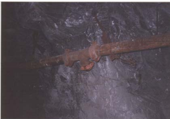
En la izquierda se muestra un empalme tipo T de 5" Ø empalmada con bridas a los tubos de fierro de 5" Ø se usan en caso de atoro para drenar el relave asentado. En la derecha una unión por platos entre una tubería de fierro de 5" Ø y una Trellex de 5" Ø.
