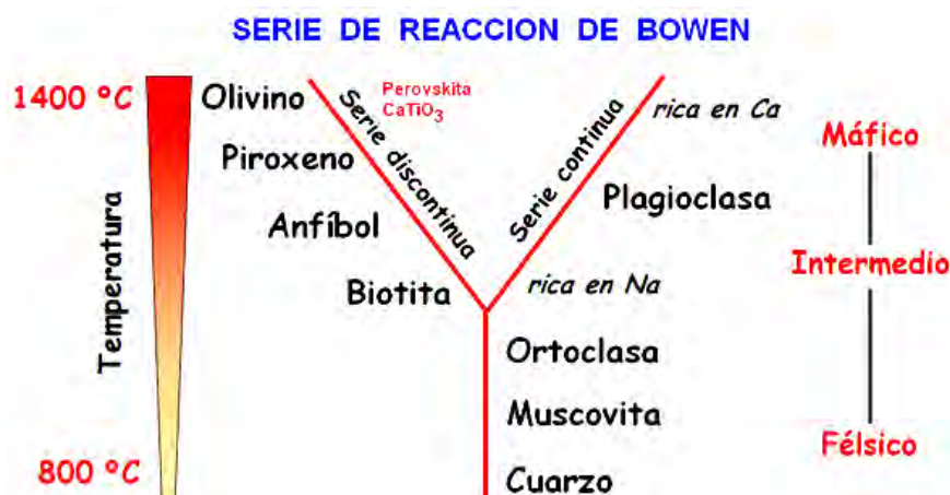
Figura 3. Proceso de cristalización de la perovskita en la serie de reacción de Bowen.
