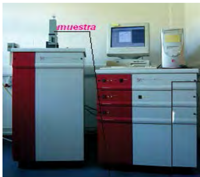
Figura 33. Equipo de Magnetización MPMS – XL con sistema de detección SQUID del Departamento de Física de la Universidad de Cambridge.
