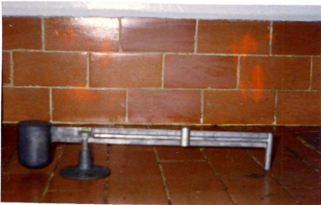
Fig. 4.4 Balanza presurizada para medir la densidad del fluido.
