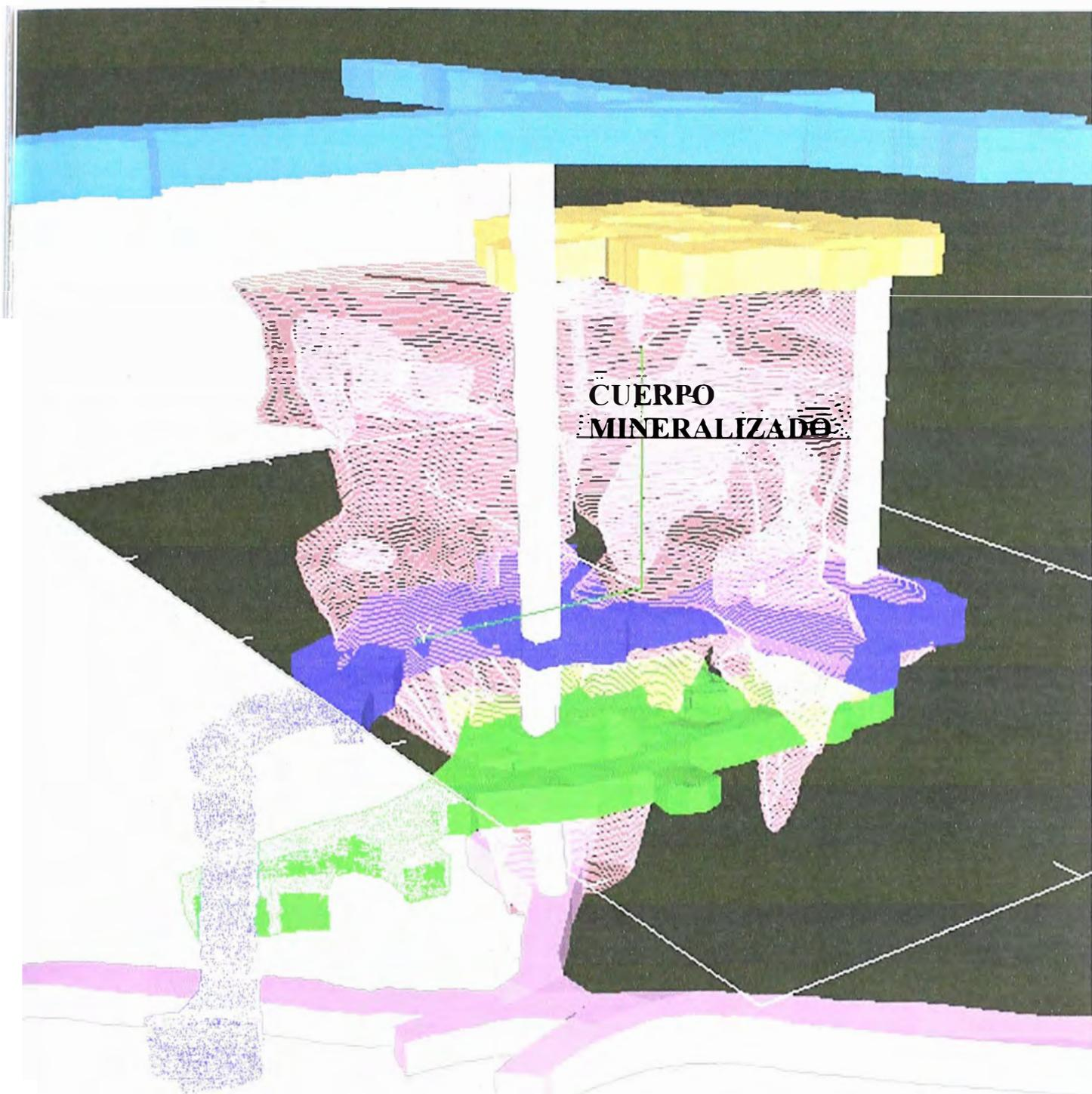
**Figura 23: Diseño en Datamine, preparaciones respecto al cuerpo**
