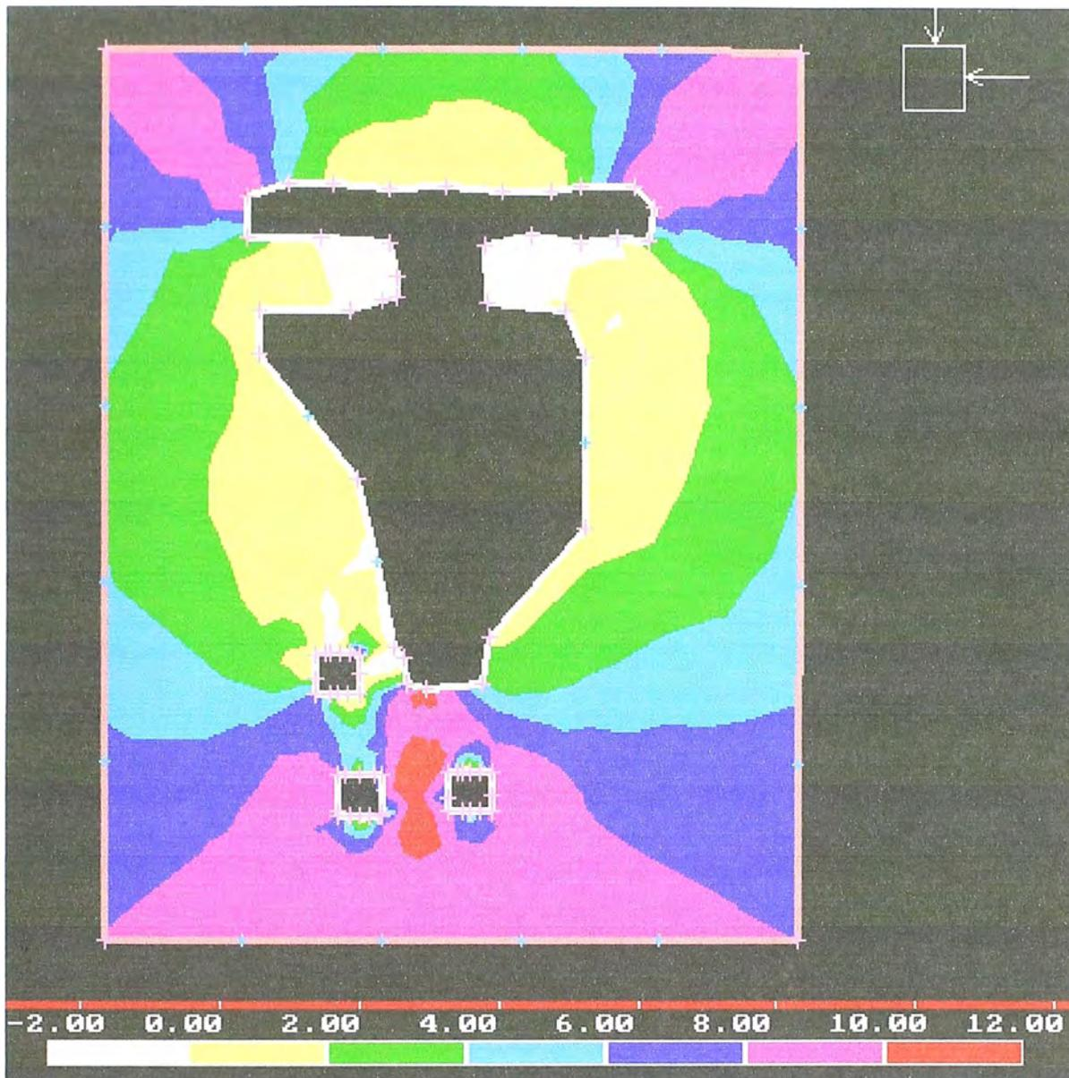
**Figura 20: Esfuerzos principales mínimos ( $\sigma_3$ ), el puente está sometido a considerables esfuerzos en los extremos del techo y parte central del piso de la excavación**
