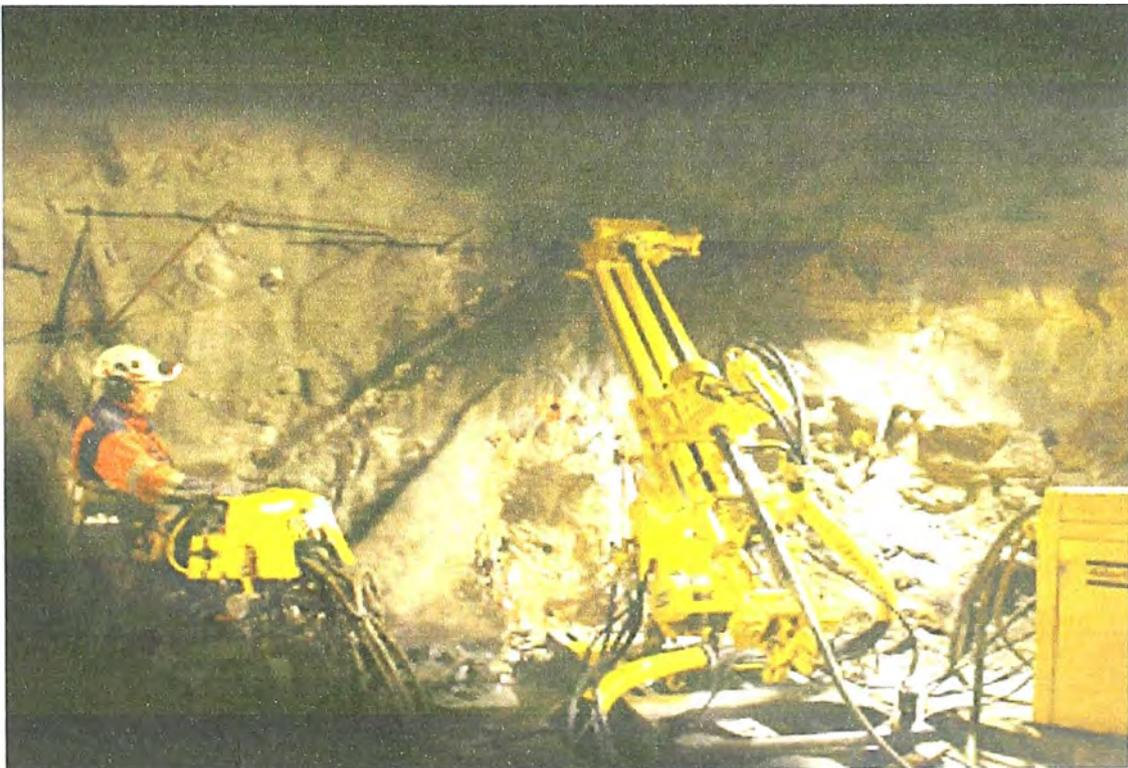
**Figura 29: DTH empleado para la perforación**
