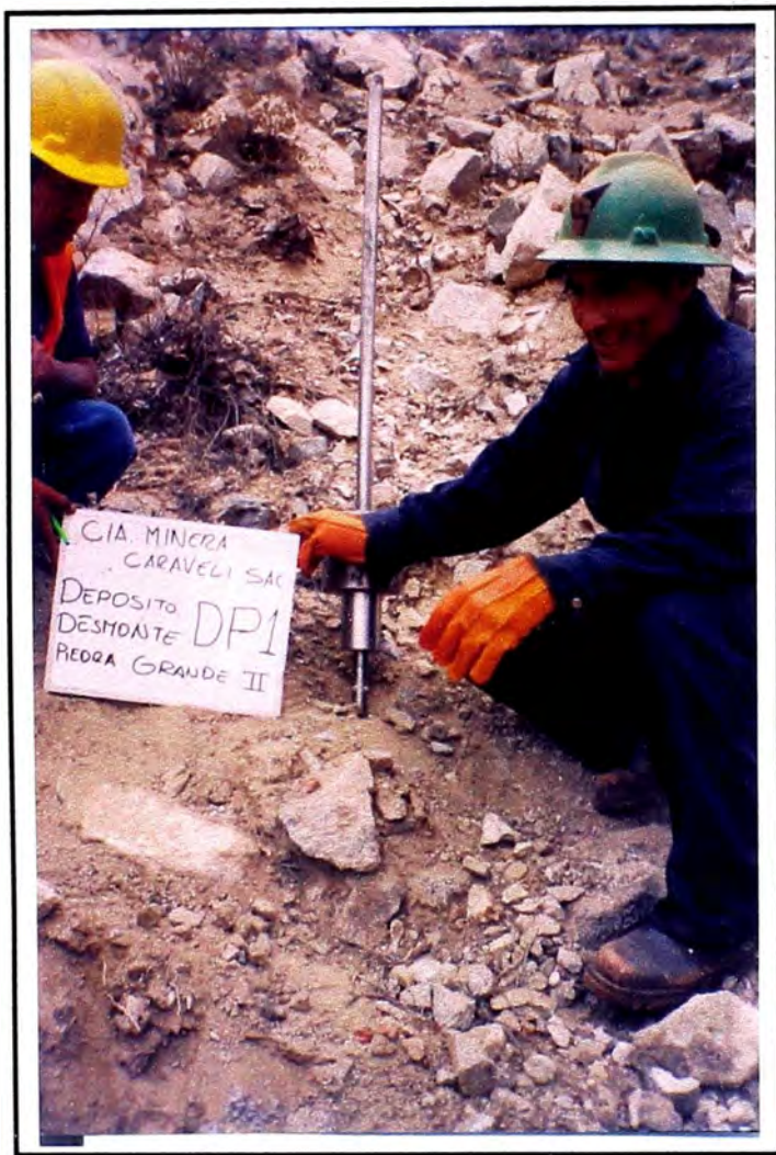
Fotografía N° 02: Vista de la ejecución del ensayo de exploración DP-1
