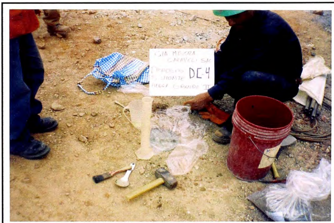
Fotografía N° 11.- Vista de la Densidad de campo DC-4.
