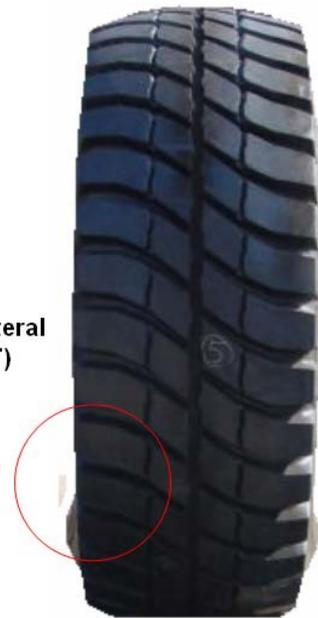
**Daños en los neumáticos debido exceso de carga y caída de material**
