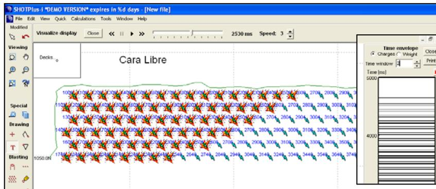
Figura 5.12 : Simulación de la voladura taladro por taladro.
