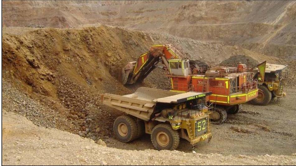
Figura 3.3: Imagen de una Pala Hidráulica Hitachi 5500 utilizadas en Minera yanacocha.
