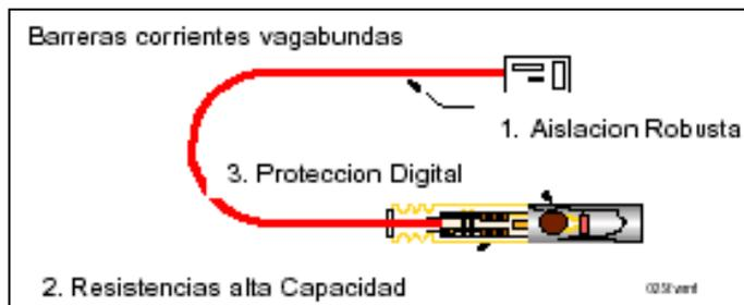
Figura 4.34. Diagrama de las barreras a corrientes vagabundas del DE.
