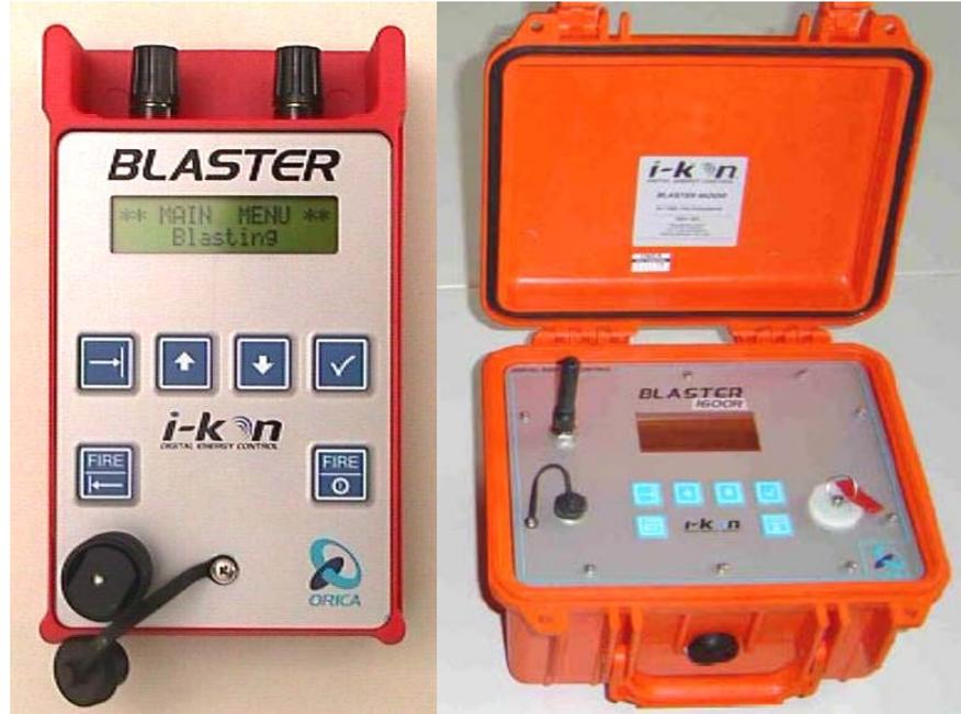
Figura 5.4 : Imagen del Blaster 400 y Blaster 2400S
