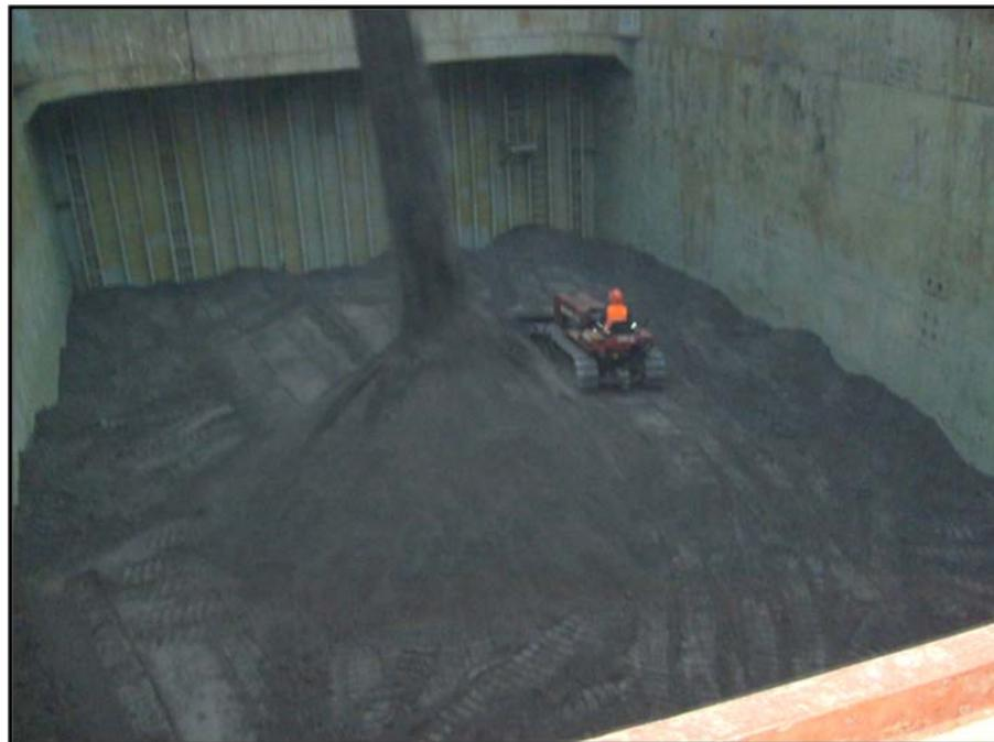
Trimado de la carga embarcada,
