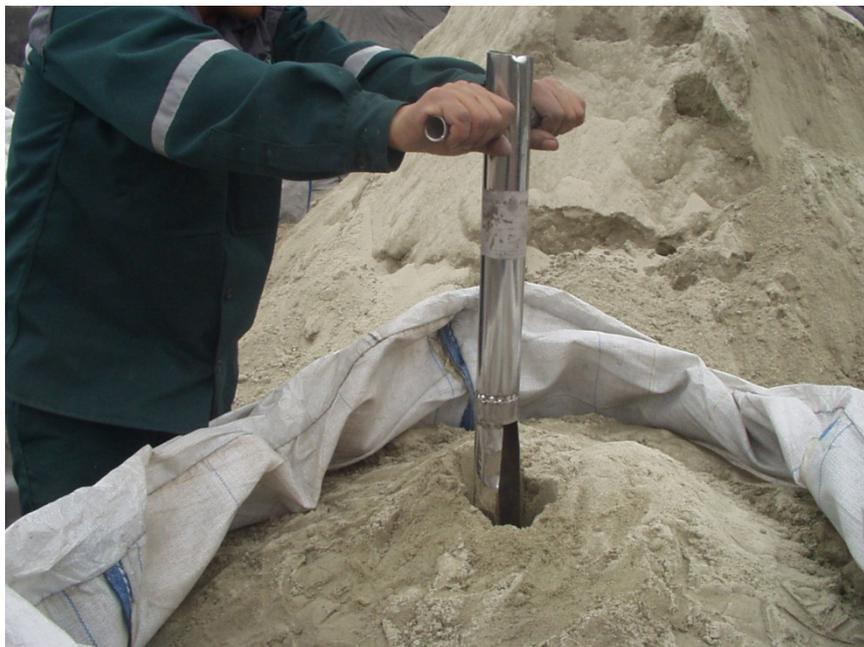
Muestreo de bolsones, 01 o 02 incrementos por bolsón, con sonda metálica tubular.
