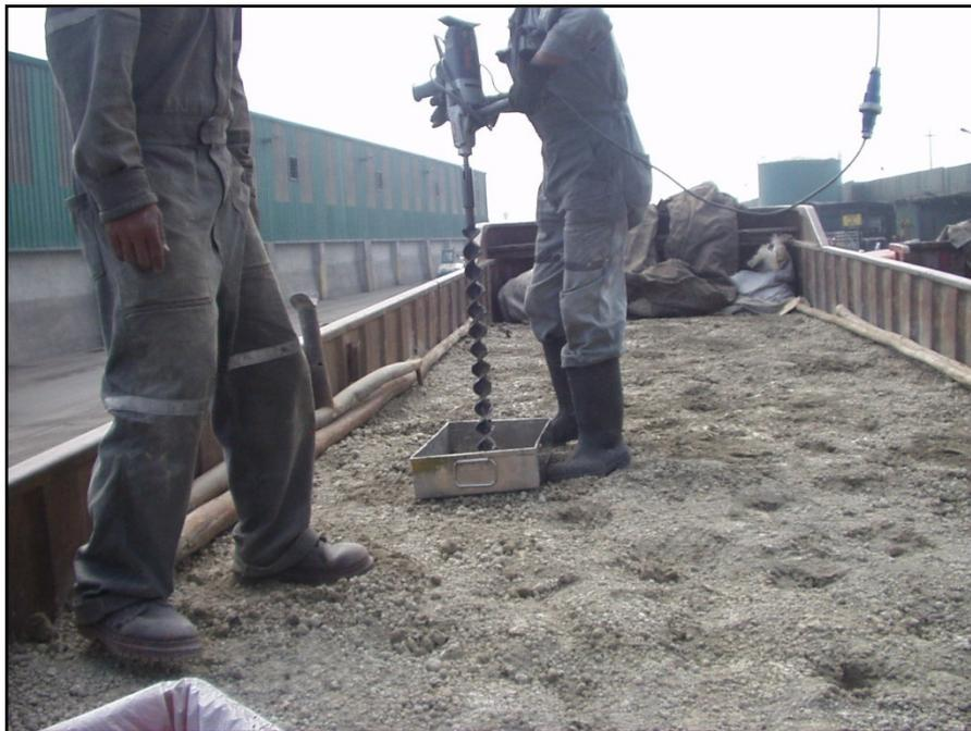
Personal de Cormin, procede a muestrear para determinar humedad, con sonda helicoidal.
