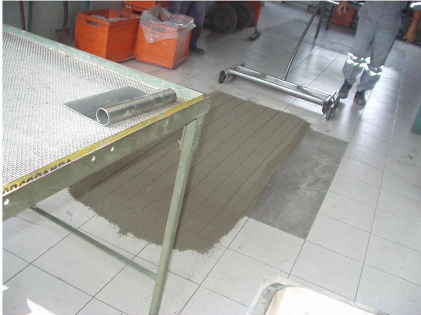
Material, tamizado, homogenizado es extendido.
