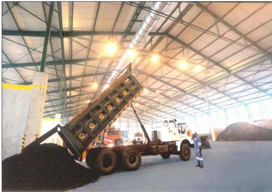
**Ilustración. Volquete descargando material (conc. plomo) en su cocha respectiva.(Encapsulado).**
