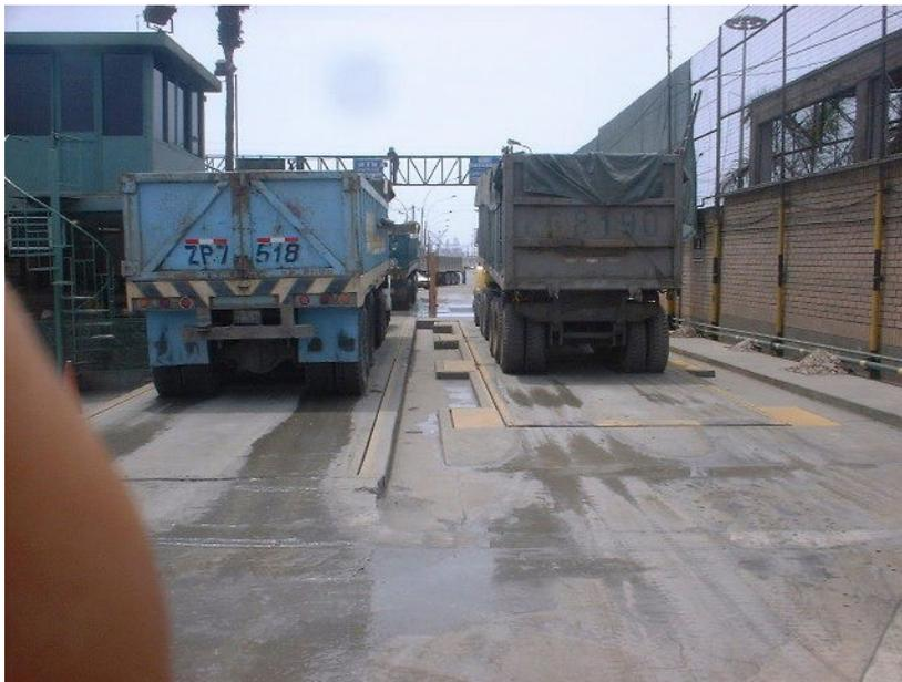
Camión descargado es destarado en la balanza, para su salida.
