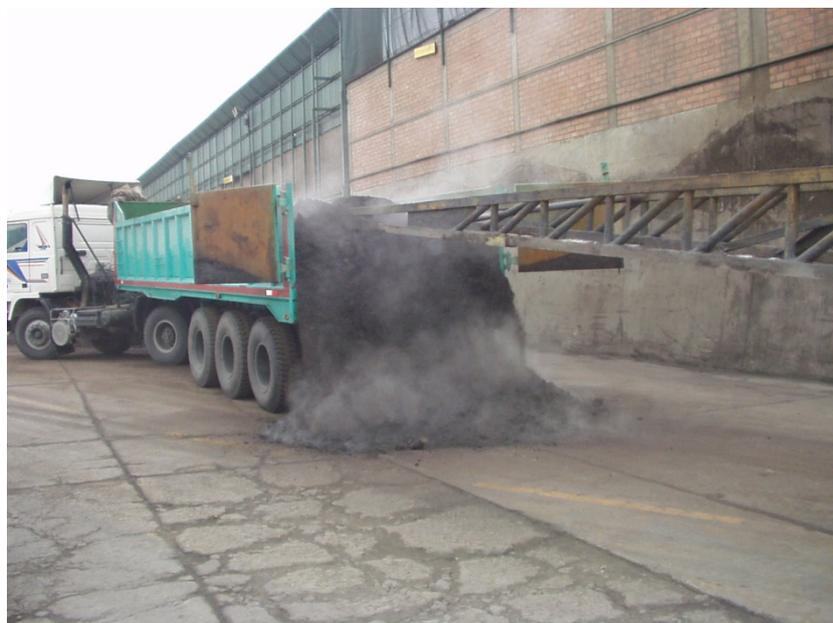
Ilustración 2. Camión siendo descargado por la rastra.
