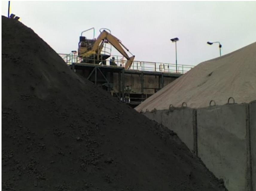
Descarga de hoppers, mediante el brazo hidráulico en la línea alta.
