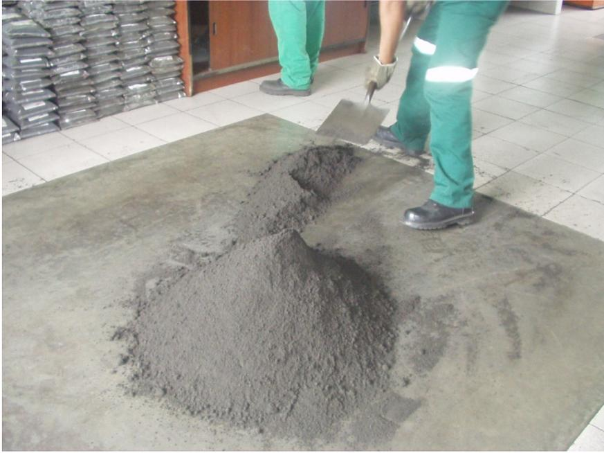
Material ya tamizado, es homogenizado por coneo.
