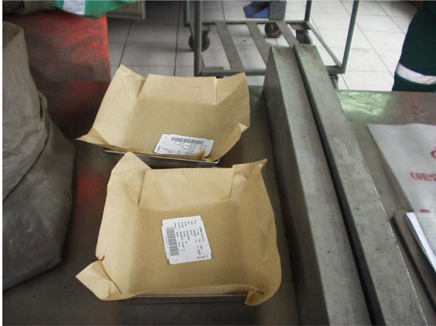
Las 02 bandejas destinadas para determinación de: contenido de humedad del material
