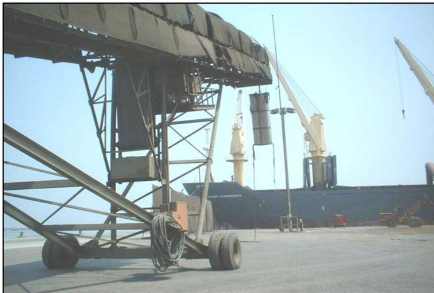
Faja transportadora móvil, en dirección hacia la bodega de la motonave.
