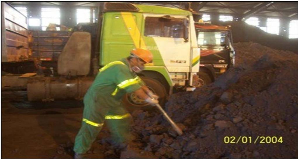
Personal de Cormin, muestrea Conc. de Plomo, con sonda tubular, dentro del encapsulado.
