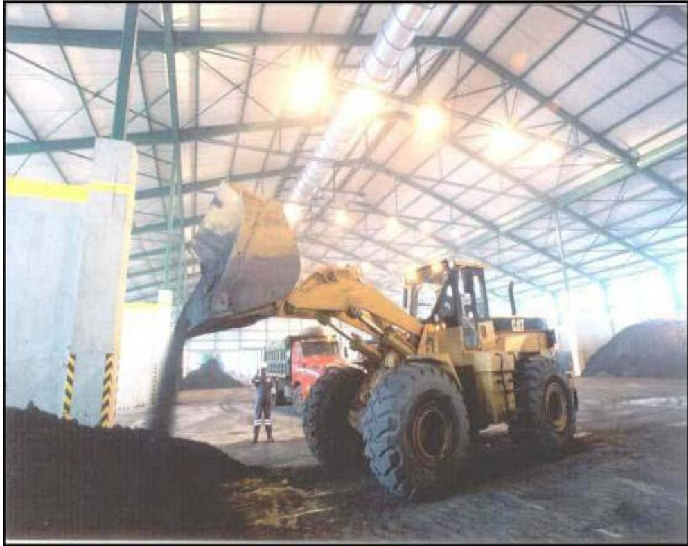
**Ilustración. Pail Lower arrumando material ( conc. plomo) descargado a su cocha respectiva.**
