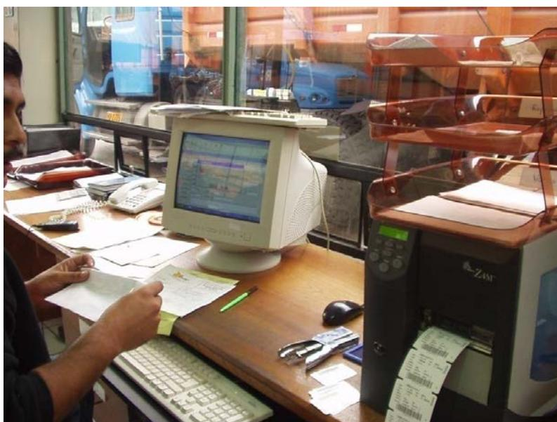
Personal de balanza de Cormin, registra peso bruto húmedo del camión y emite tickets para su descarga.
