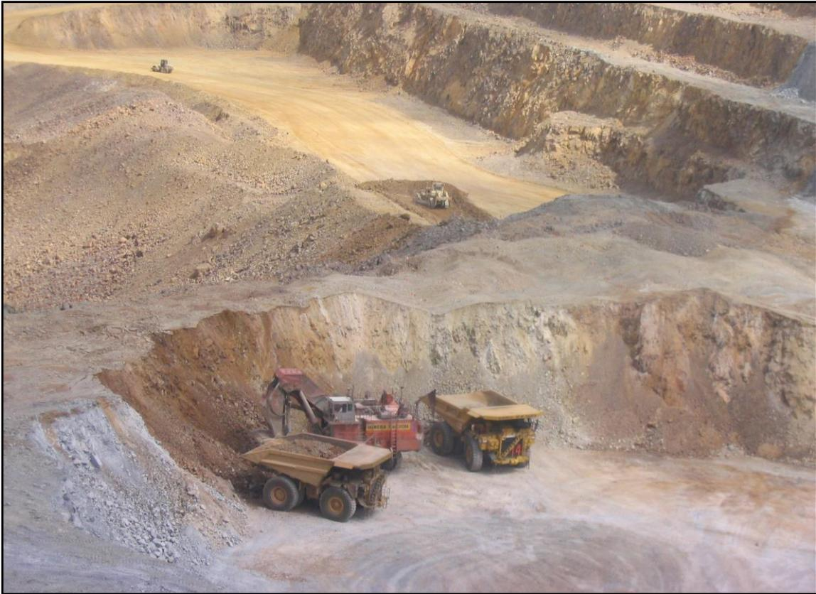
**FOTOGRAFÍA 09.** Ciclo de minado casi completo, perforación, avance con el amarre de los taladros para voladura, carguío, acarreo y servicios auxiliares para mantenimiento de vías y para ayudar a controlar los pisos de los equipos de carguío.
