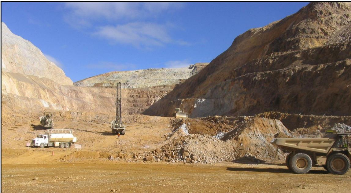
**FOTOGRAFÍA 04.** Carguío con Pala Hitachi 5500 y camiones caterpillar 785 y 793.
