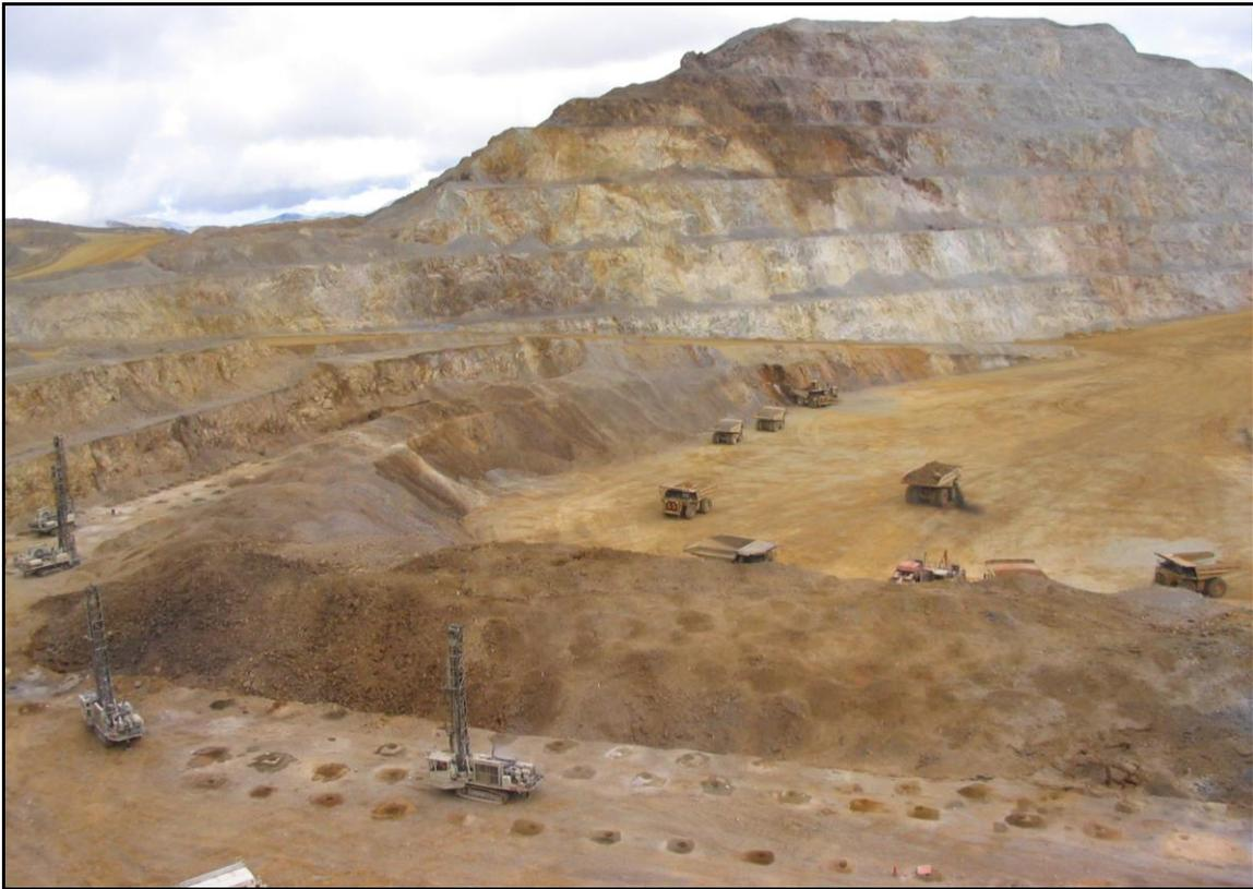
**FOTOGRAFÍA 03.** Perforación en una rampa en la fase III mina Yanacocha.
