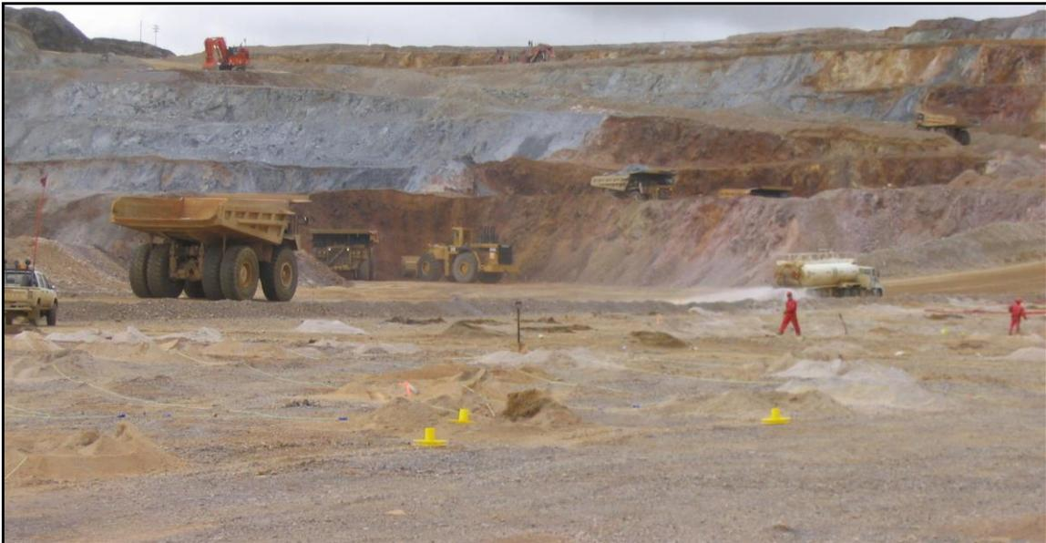
**FOTOGRAFÍA 07.** Acarreo en la mina Yanacocha usando rampa hacia los botaderos y pads.
