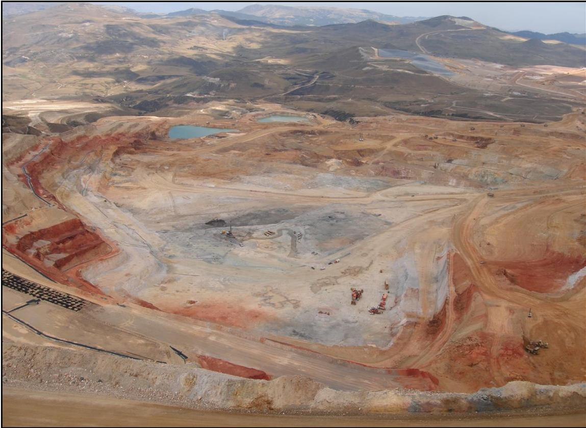
**FOTOGRAFÍA 18.** Perfilado de paredes finales según parámetros geotécnicos
