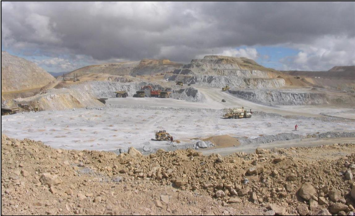
**FOTOGRAFÍA 06.** Carguío, acarreo en la mina Yanacocha y amarre de taladros para la voladura del banco inferior.
