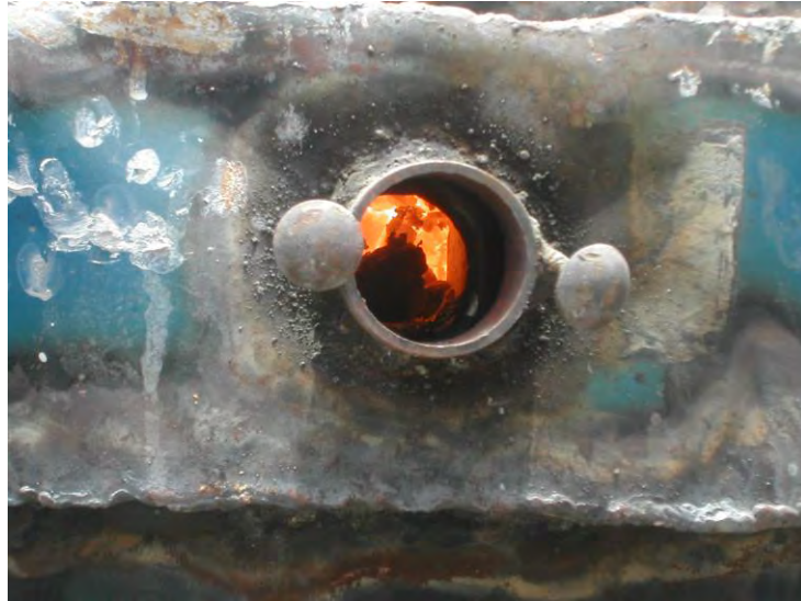
Fotografía N° 5 Vista de la tobera observando las gotas de hierro fundido
