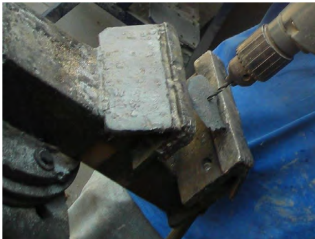
Fotografía N° 4 Taladrando el Material obtenido con broca de ¼"Ø
