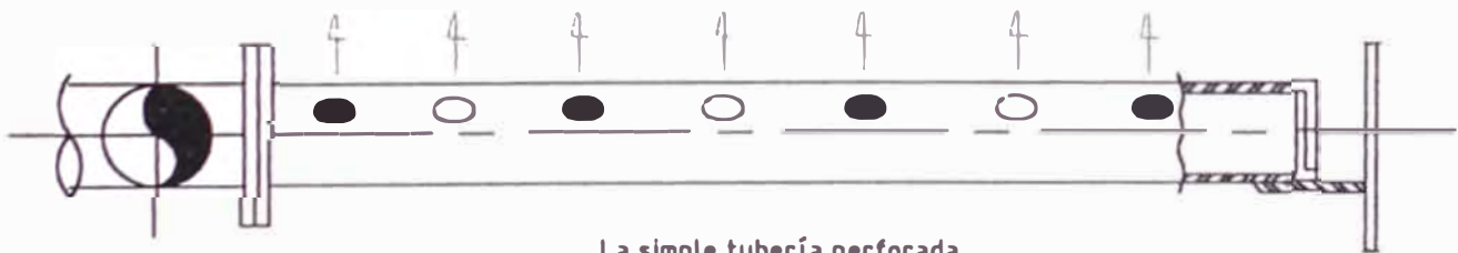
La simple tubería perforada Uno de los tipos más usados como distribuidor
