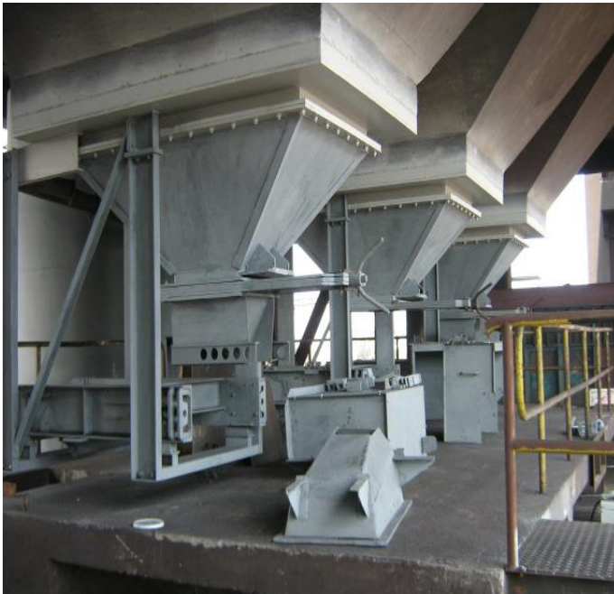
Descarga de tolvas y balanza antes de ingresar al horno R.D. n° 3
