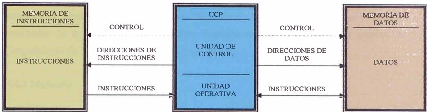
Figura 1.11: . La arquitectura Harvard dispone de dos memorias independientes para datos y para instrucciones, permitiendo accesos simultáneos.
