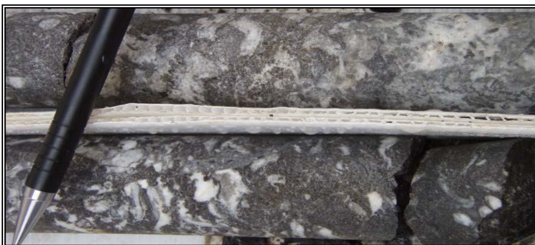
Foto 10. DDH-CR-06, a 833m. , doloesparita (rudstone) fosilífera con WSD y bitumen en venillas.
