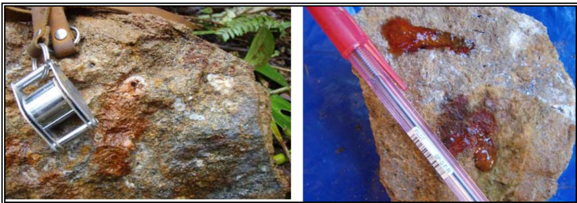
Fotos 17 y 18. Muestras del área “Anita”, Izquierda: Doloesparita con esfalerita pervasiva, nótese los óxidos de zinc. Derecha: abundante presencia de óxidos de zinc reaccionando intensamente al Zinc Zap.
