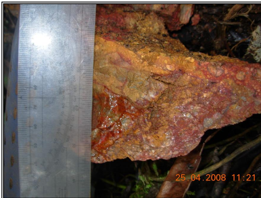
Foto 23. Dolomita brechada con fragmentos subredondeados reaccionando de débil a moderadamente al “Zinc Zap” en afloramientos ubicados en Charlita.
