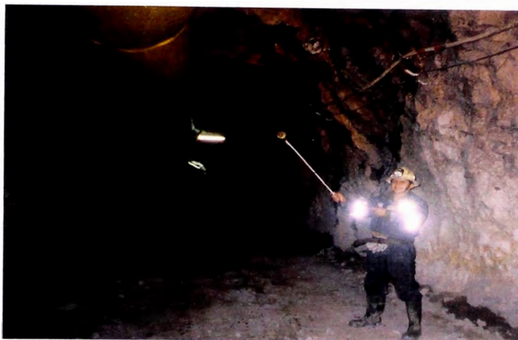
Foto N° 1: Medición con Termo Hidro Anemómetro de Velocidad de Aire, Temperatura y HR.
