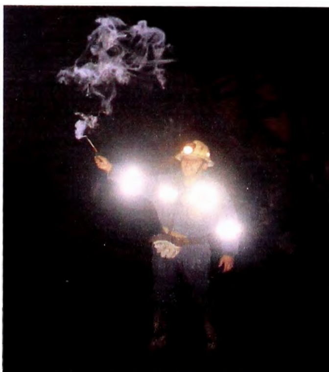
Foto N° 2: Medición de Corriente de Aire con Tubos de Humo.
