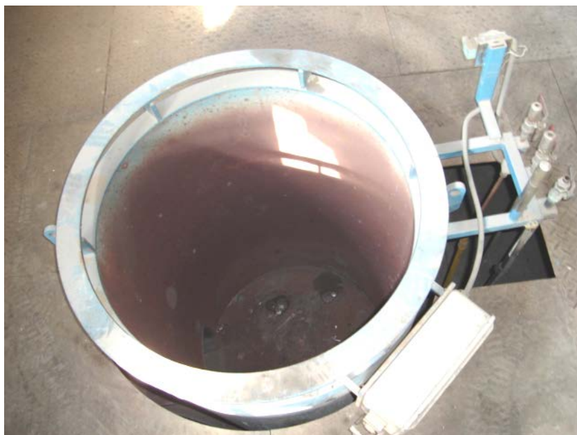
Figura 2.4. Cámara de enfriamiento para las matrices.
