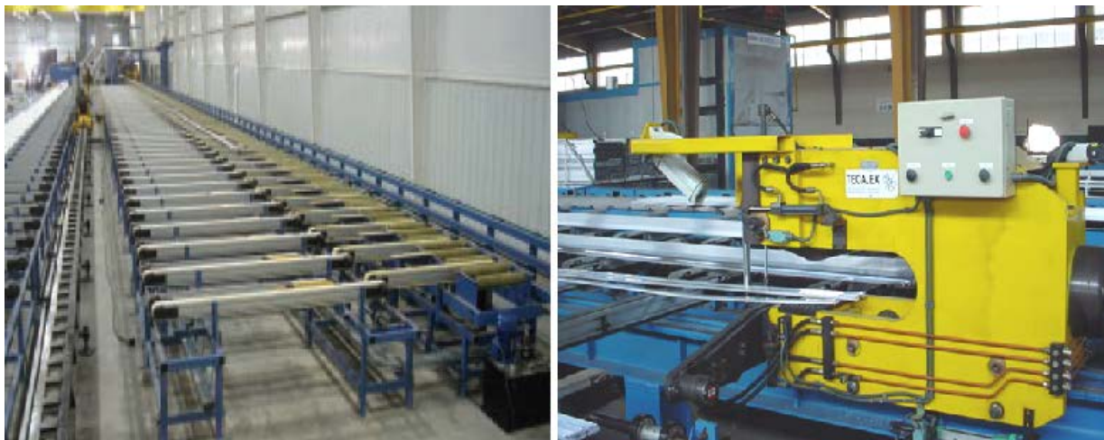
Figura 1.9. Mesa de enfriamiento (izquierda) y estirador fijo (derecha).
