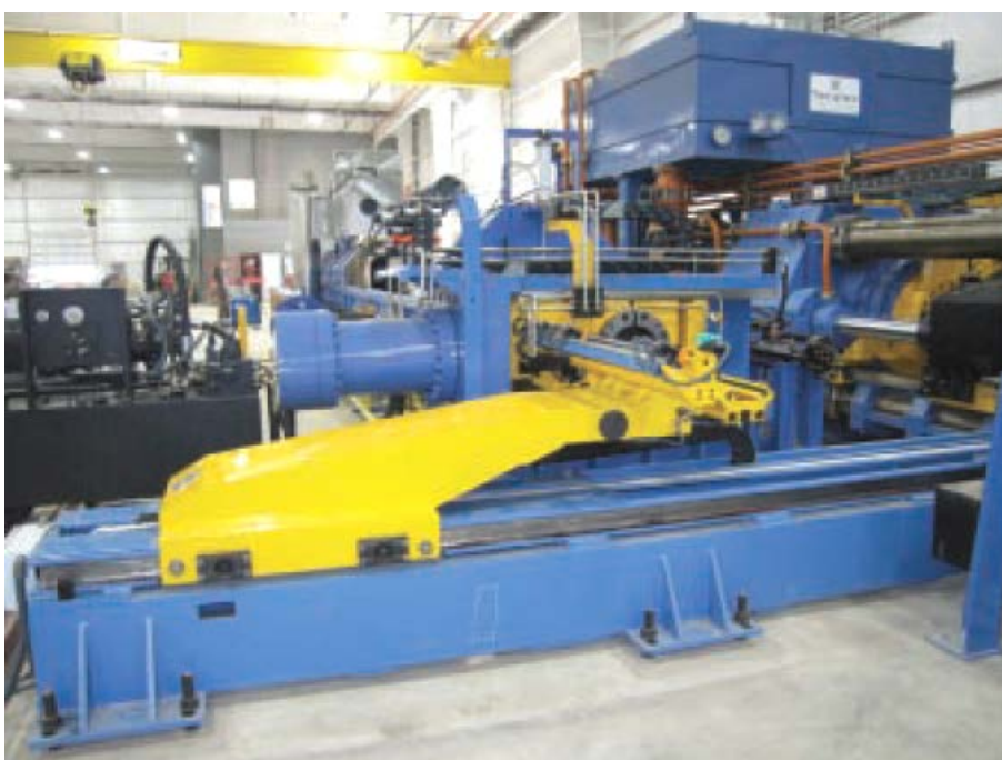
Figura 1.5. Cizalla en caliente y robot.
