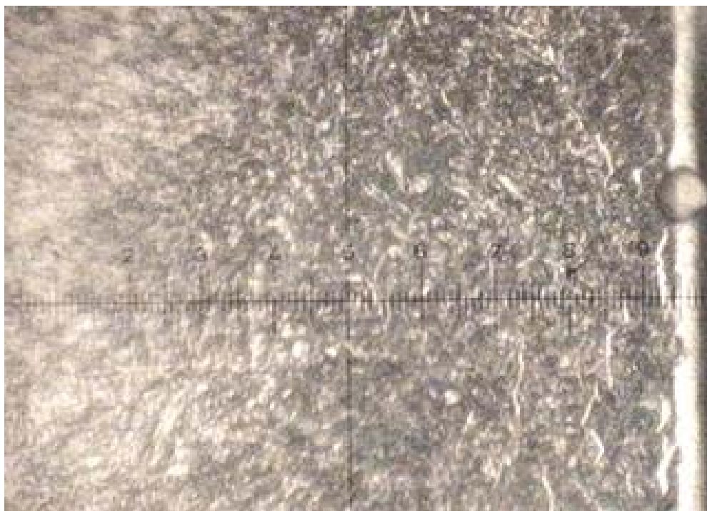
Figura 2.21. Grafico de perfil de microdureza correspondiente a un acero H13 con recubrimiento superficial. Disociación de 31%.
