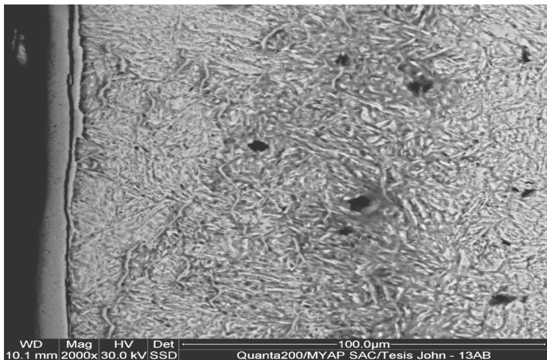
Figura 2.7. Fotomicrografías por SEM donde se observa la morfología y análisis químico de la probeta. Se observa una capa blanca no homogénea de 4 y 5µm, martensita revenida y carburo globular fino.
