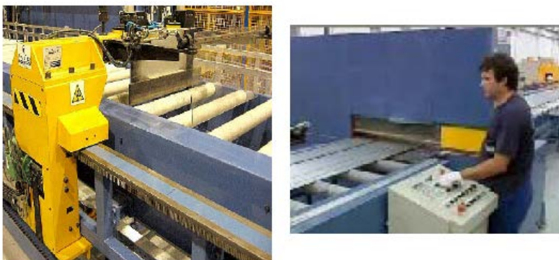
Figura 1.10. Maquina de corte (derecha) y tope (izquierdo).
