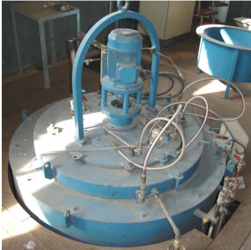
Figura 2.3. Cámara donde se introducen la cesta con las matrices.
