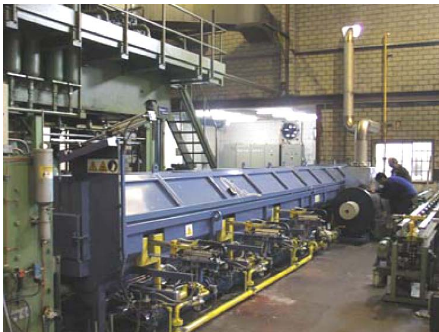
Figura 1.4. Horno de calentamiento de billet
