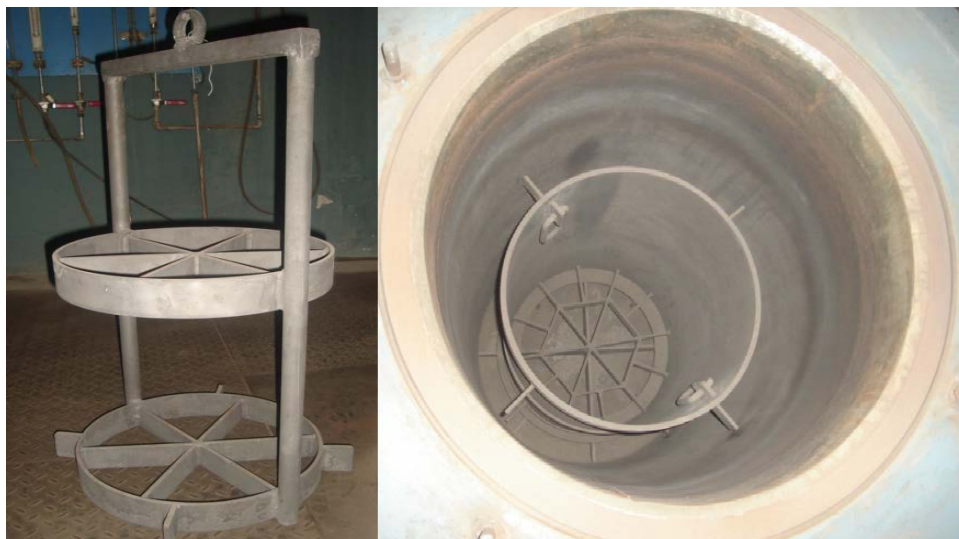
Figura 2.5: Cesta donde se colocan las matrices para nitrocarburation y en el lado derecho la retorta.
