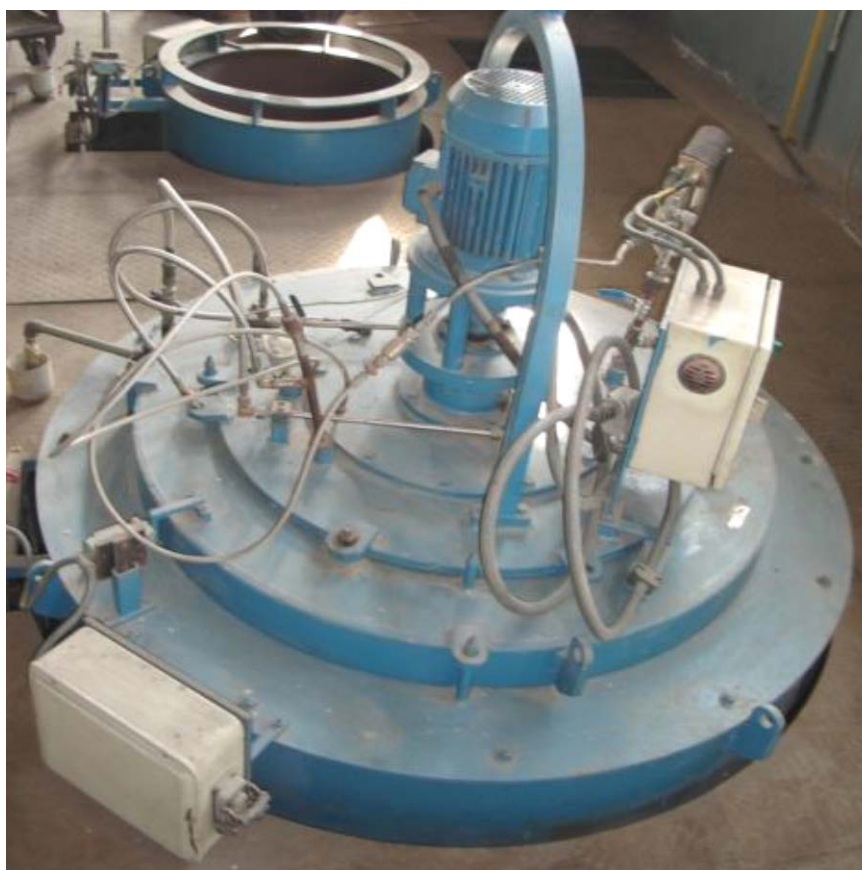
Figura 2.2. Estructura principal del horno de nitrocarburo.
